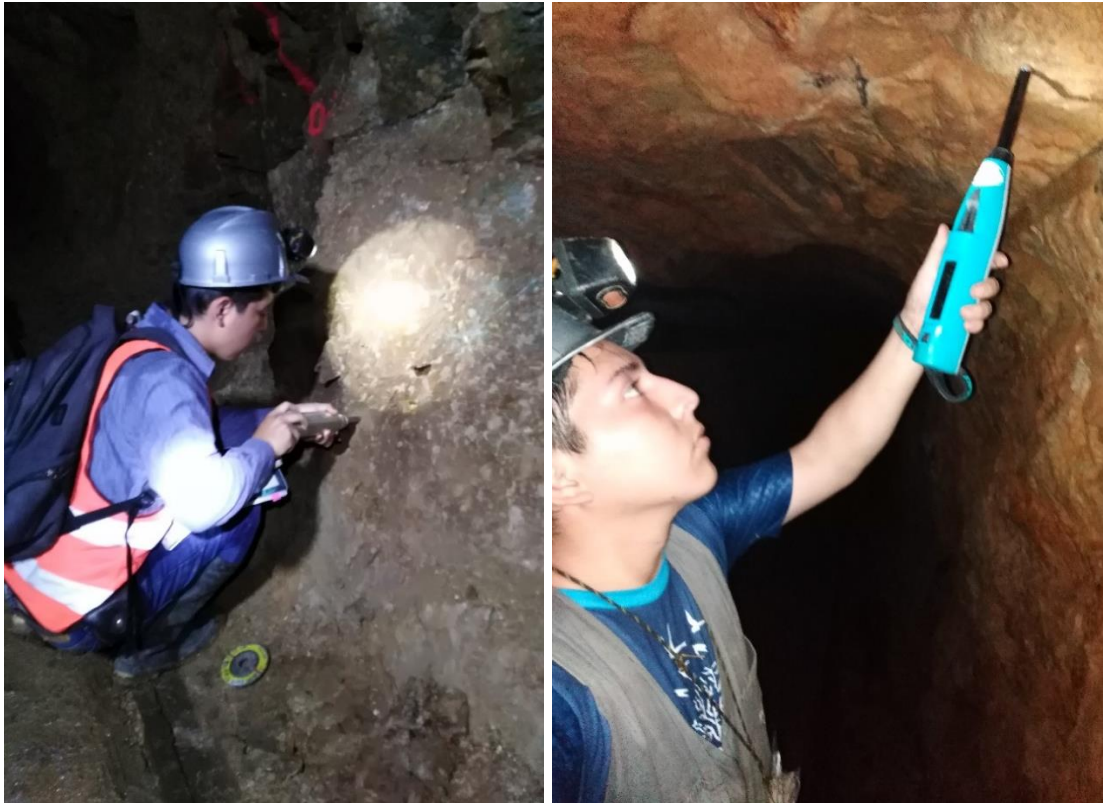
Fotografía 4, 5. Toma de puntos con el esclerómetro (izquierda pared) (derecha techo). Fuente: El Autor, 2022
