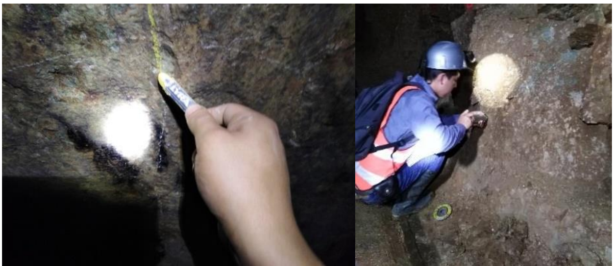
Trazado de la malla para ensayo con esclerómetro (izquierda), ensayo con esclerómetro (derecha)
