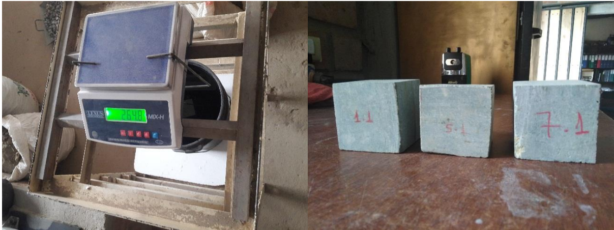
Balanza para pesado de cubos (izquierda), cubos probetas de roca para laboratorio (derecha)
