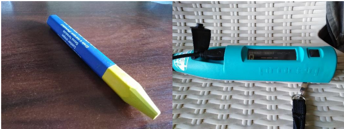
Lápiz para roca (izquierda), esclerómetro digital N (derecha)
