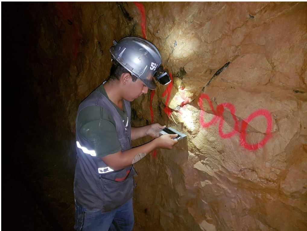
Fotografía 9. Aplicación del perfilómetro. Fuente: El Autor, 2022
