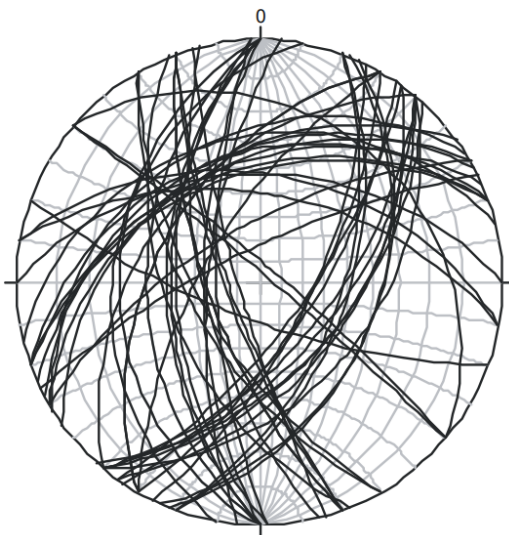
Figura 5. Diagrama de círculos máximos (beta). (correspondiente al estudio de un macizo rocoso de calcarenitas bioclásticas).
