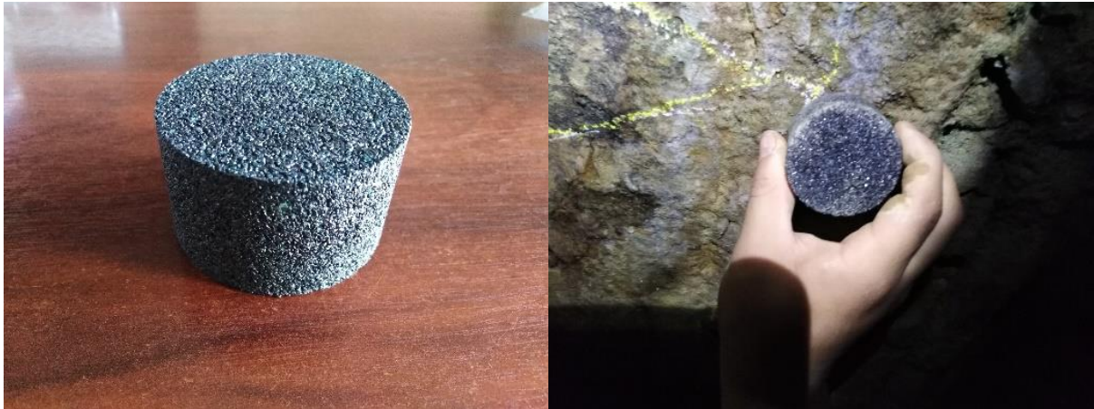
Esmeril para roca (izquierda) y esmerilado en la galería (derecha)
