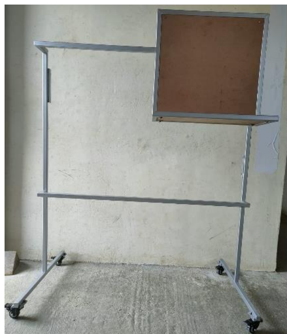
Estructura del banco de cierre centralizado (fase final)
