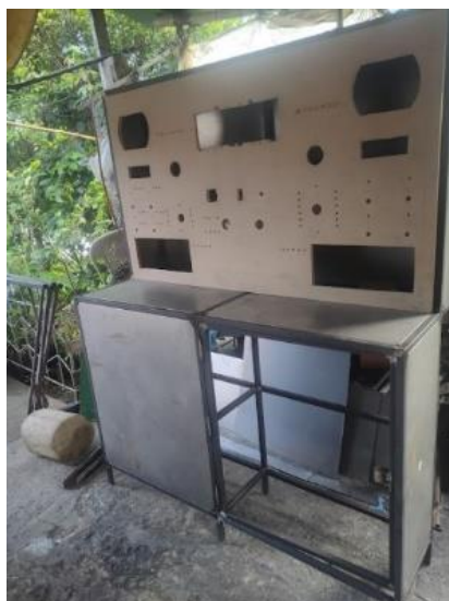
Estructura del banco de luces con recubrimiento
