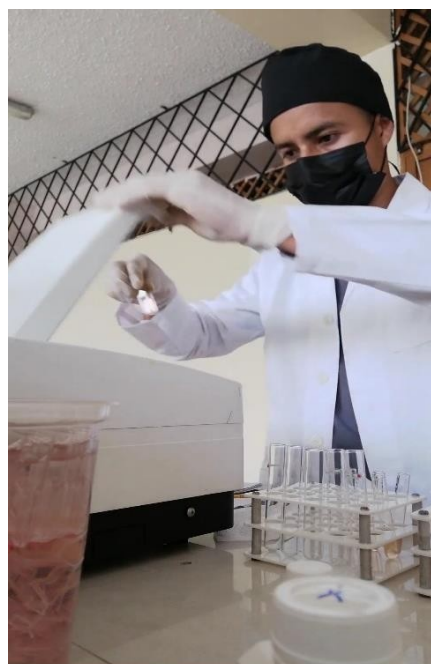
Descripción: Ubicación de la cubeta en el espectrofotómetro UV-1100.
