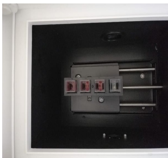
Descripción: Ubicación de la cubeta en el espectrofotómetro UV-1100, una cubeta de agua destilada y tres cubetas para realizar la medición del analito.
