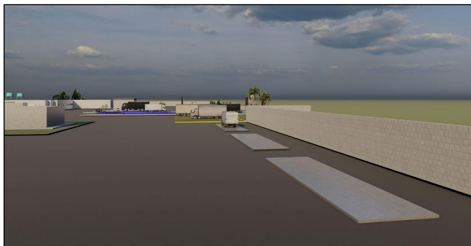
Figura 14. área de limpieza y desinfección de vehículos pesados.
