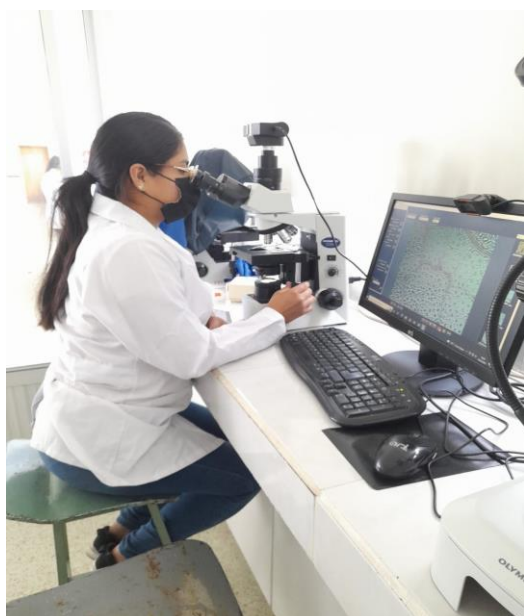
Figura 16. Observación y cuantificación de estomas mediante el método de improntas.
