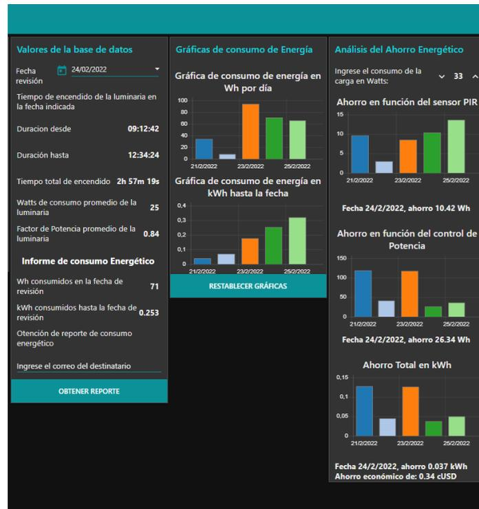
Figura 119 Interfaz Datos energía, visualización del ahorro energético
