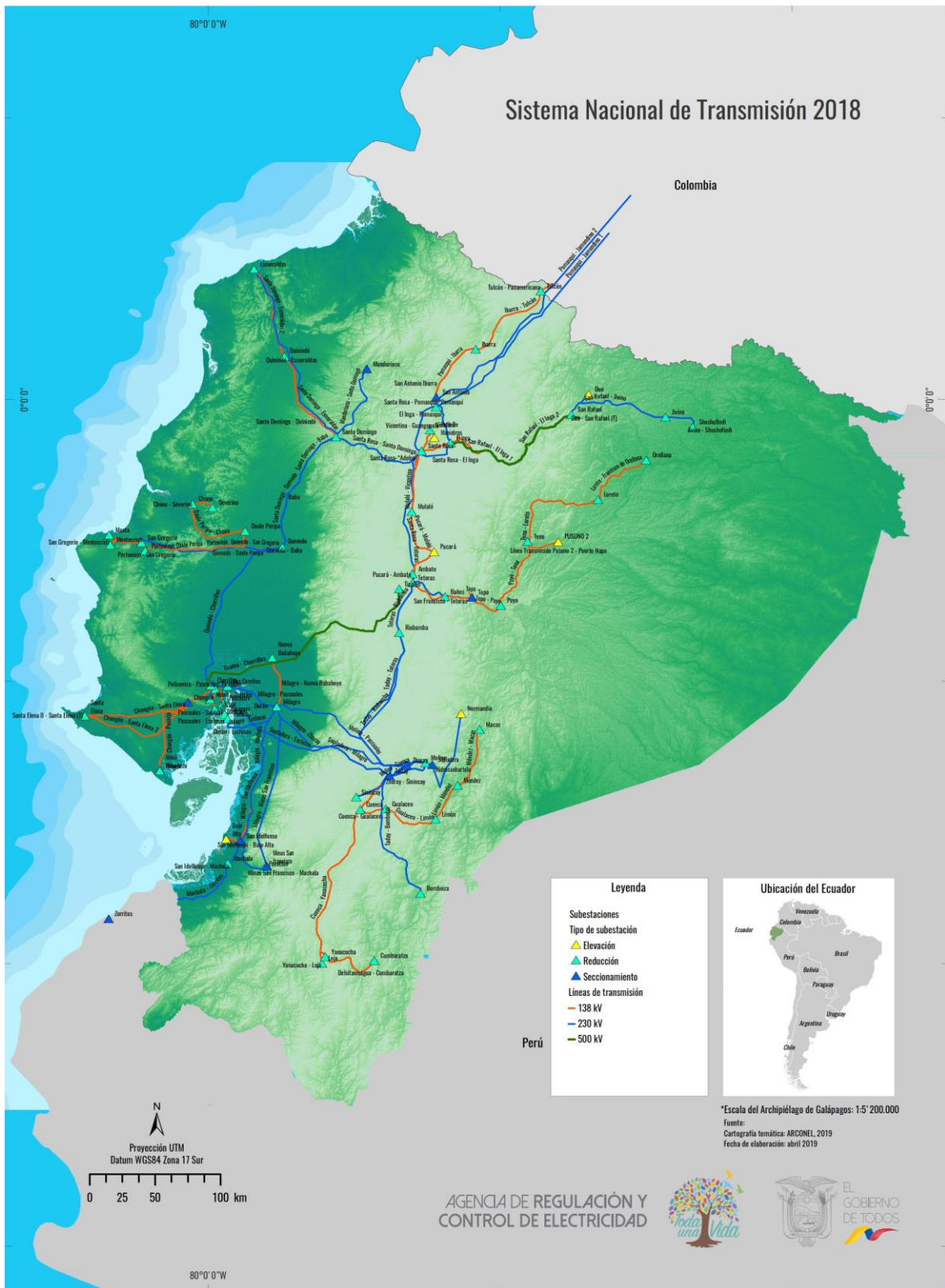
Figura 6. Esquema geográfico del Sistema Nacional de Transmisión - Año 2018. Fuente. (CONELEC, 2018)
