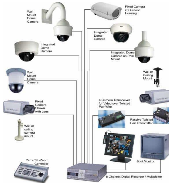
Figura 3. Esquema de un Circuito Cerrado de Televisión (CCTV)
