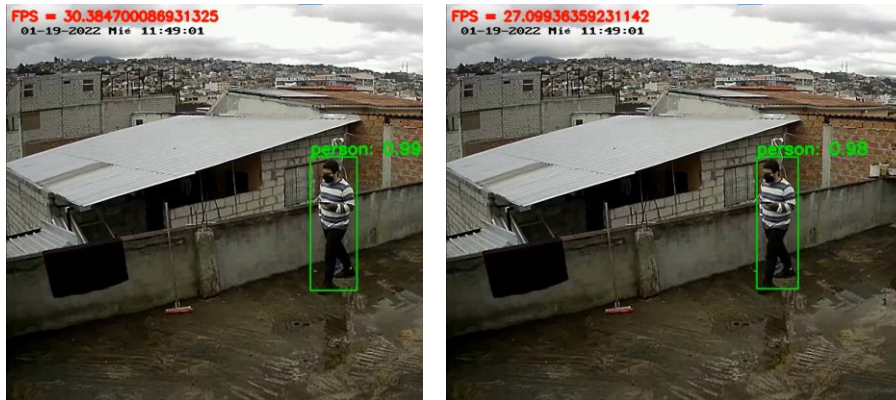
Figura 19. Comparación entre modelos de detección: Personalizado vs Preentrenado. Fuente: Elaborado por el autor.
