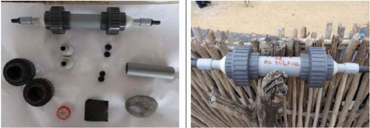
Figura 19 Materiales y filtro desulfurador Nota: Adaptada de (CIDAR, 2016)
