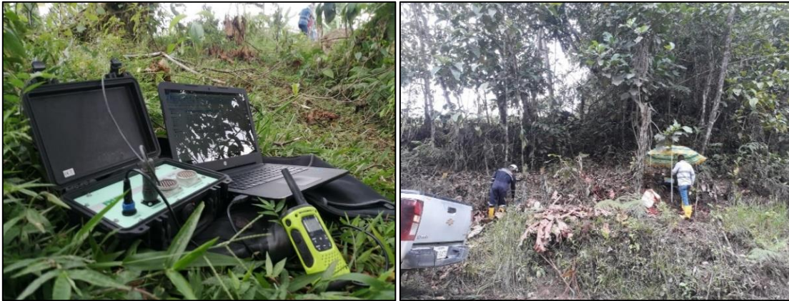
Figura 26. Equipo de Sísmica PASI GEA24 (Izquierda) y Tendido de cables (Derecha)
