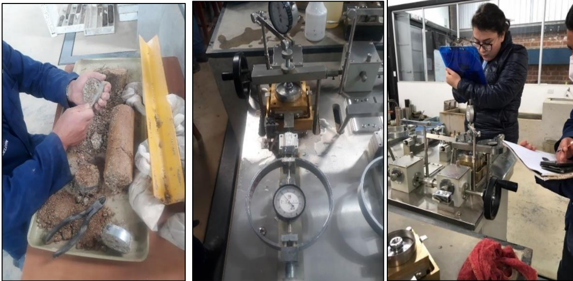
Figura 28. Proceso para llevar a cabo el ensayo de corte directo
