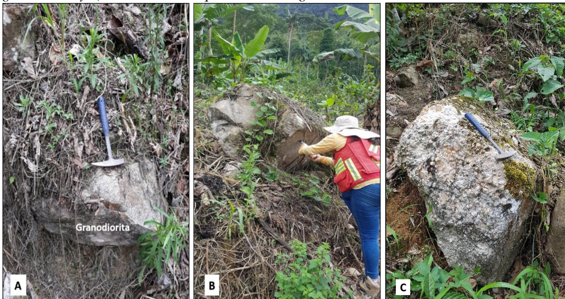
Figura 42. a) Presencia de bloques granodioríticos, b) Toma de resistencia de un bloque de granodiorita y c) Presencia de bloque de microconglomerado.
