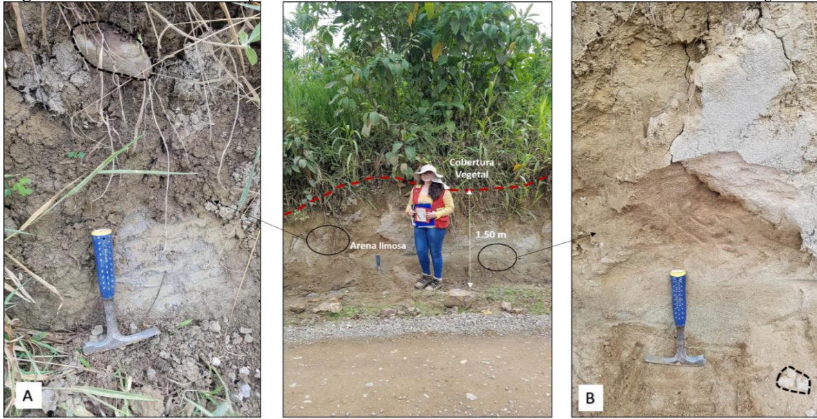
Figura 35. a) Arena limosa café claro, b) Arena limosa de tonalidad marrón con tonalidades grisáceas
