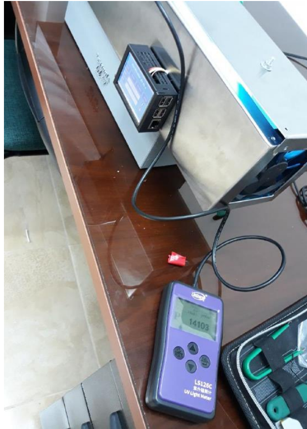
Medición de potencia UV en el punto cercano al foco de radiación.
