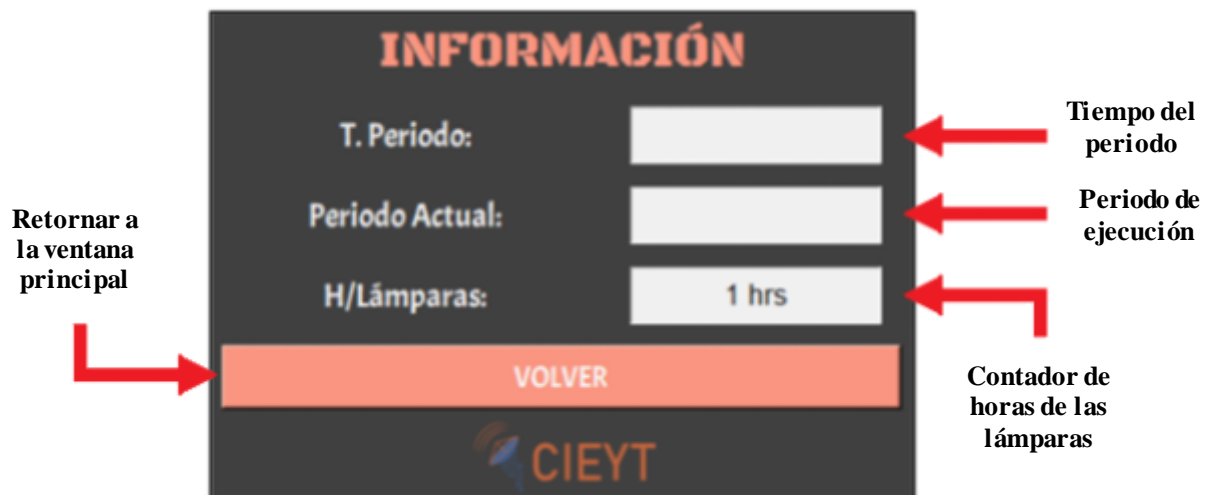
Figura 3.- Ventana de información de operación y contador de horas de trabajo.
