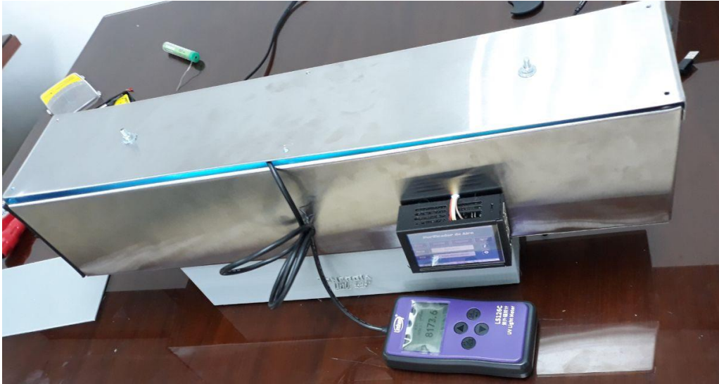
Medición de potencia de radiación en el punto lejano de la sección transversal.
