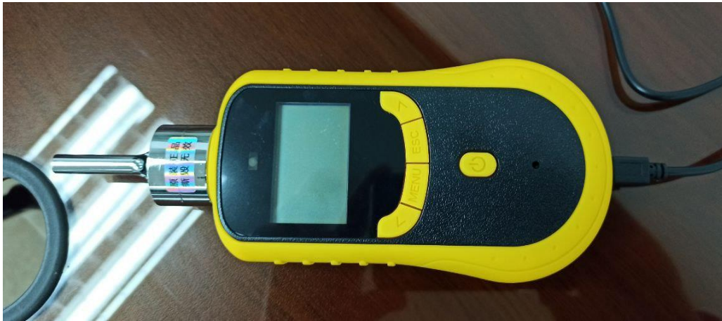
Medidor de concentración de gas (Ozono).
