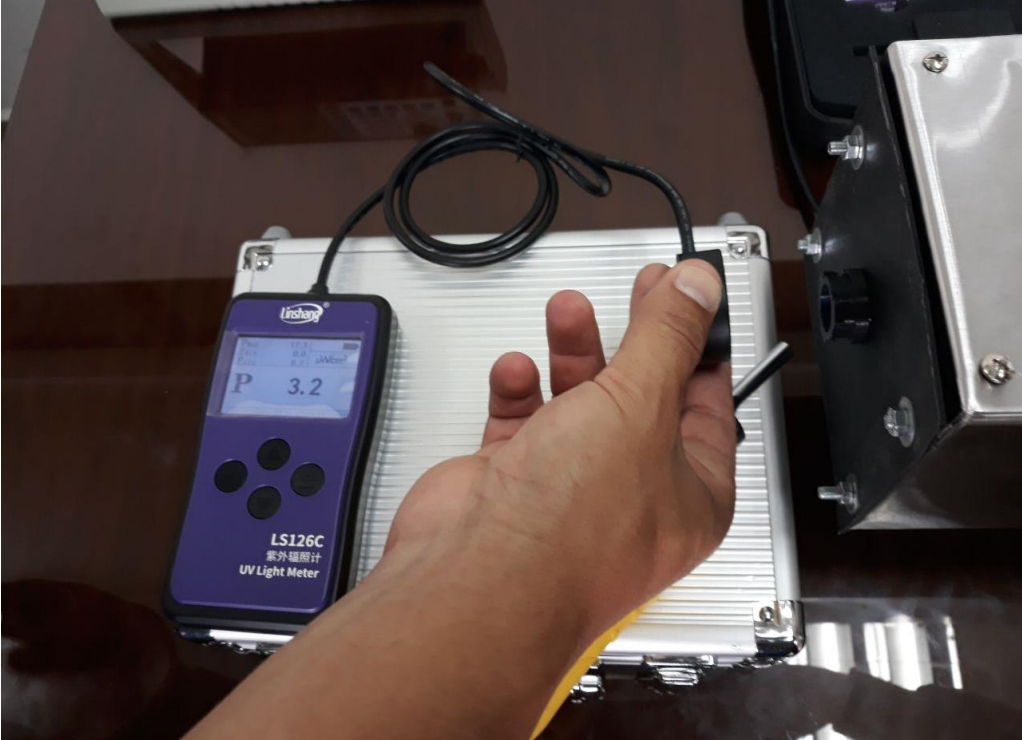
Medición en etapa de calentamiento (extremo de salida).
