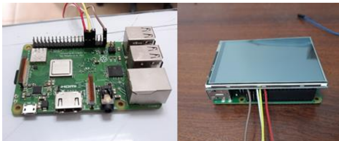
Figura 15. Unidad de control, Raspberry Pi 3 B+ con pantalla táctil
