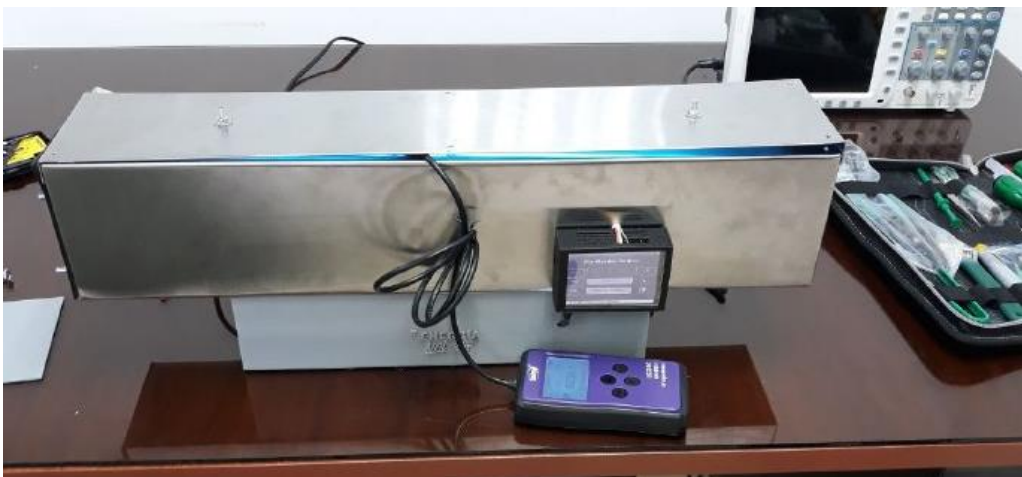
Medición de potencia UV en el punto medio respecto al foco de radiación.
