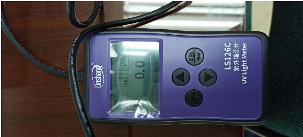
Medidor de intensidad de radiación (radiómetro).
