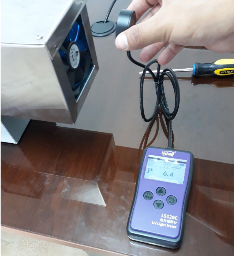
Medición en etapa de calentamiento (extremo de entrada).
