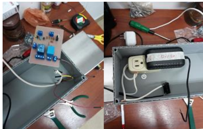
Figura 17. Acoplamiento de los elementos electrónicos en el volumen de PLA
