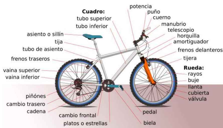
Figura 1. Partes que conforman una bicicleta estándar
