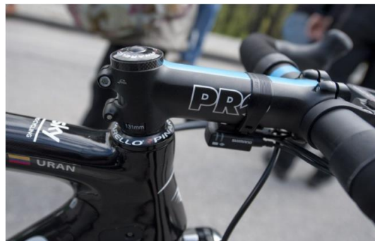
Figura 31. Potencia para bicicleta de carretera Nota. Fuente: (Valero 2020)
