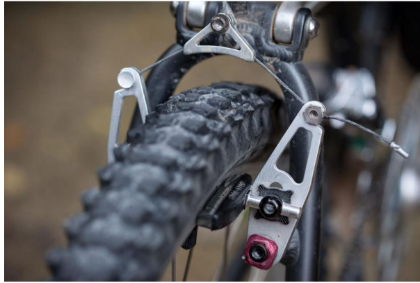
Figura 25. Frenos cantiléver de tiro central
