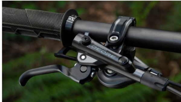
Figura 33. Maneta de freno hidráulico SHIMANO DEORE I-SPEC EV BL-M6100 Nota. Fuente: (SHIMANO 2021b)
