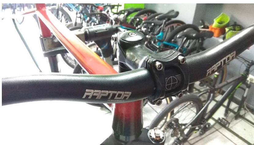
Figura 74. Instalación de la suspensión delantera y el manubrio Nota. Fuente: Autor
