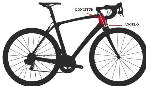
Figura 3. Tubo direccional en una bicicleta estándar
