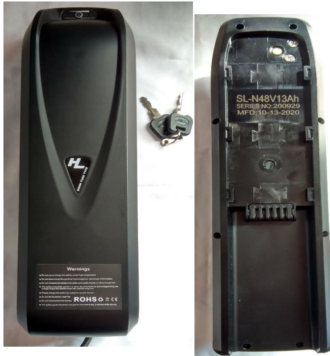
Figura 71. Batería de litio 48 V 13 Ah marca Hailong Plus Nota. Fuente: Autor
