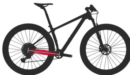
Figura 6. Longitud de la vaina de una bicicleta estándar Nota. Fuente: (Arango 2019)
