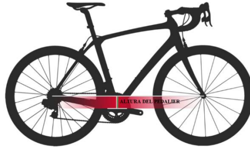
Figura 7. Altura del pedalier de una bicicleta estándar Nota. Fuente:(Arango 2019)
