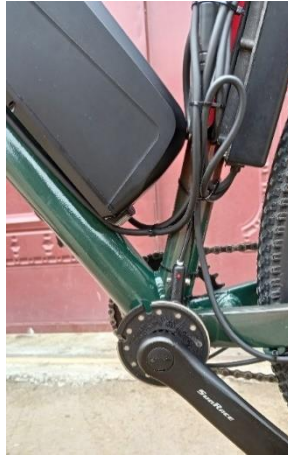
Figura 79. Ubicación del sensor de pedaleo, disco magnético y controlador en la bicicleta Nota. Fuente: Autor
