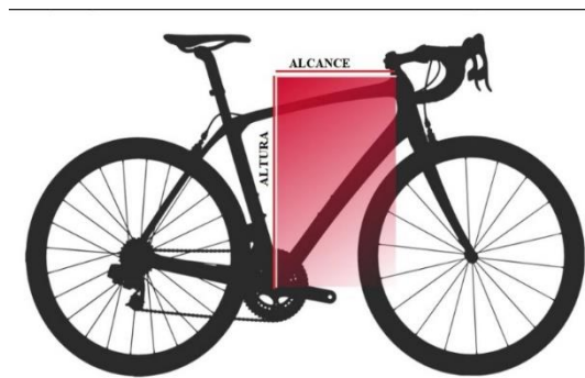
Figura 2. Altura y alcance de una bicicleta estándar Nota. Fuente: (Arango 2019)
