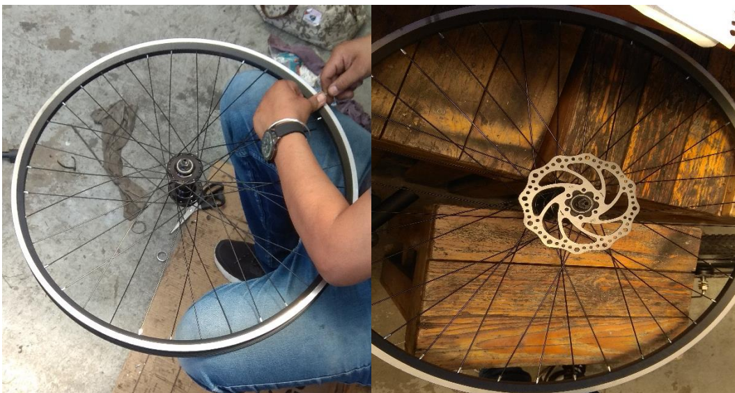
Figura 76. Radiado de la rueda delantera y montaje del disco de freno
