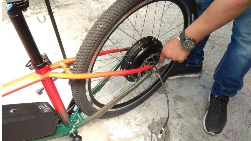
Figura 77. Montaje de la rueda en la horquilla de enganche trasera Nota. Fuente: Autor
