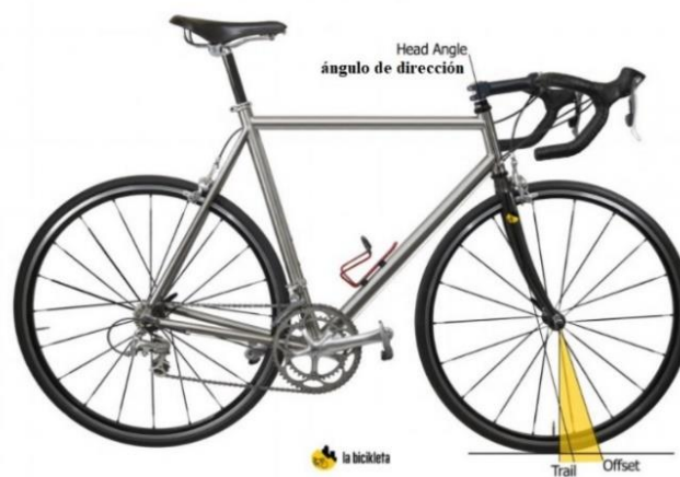
Figura 4. Offset (compensación) y Trail (rastros) de una bicicleta estándar
