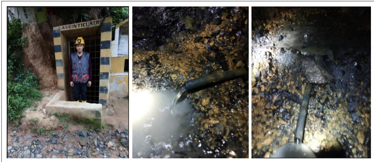
Figura 3. Determinación del caudal del DAM en campo.
