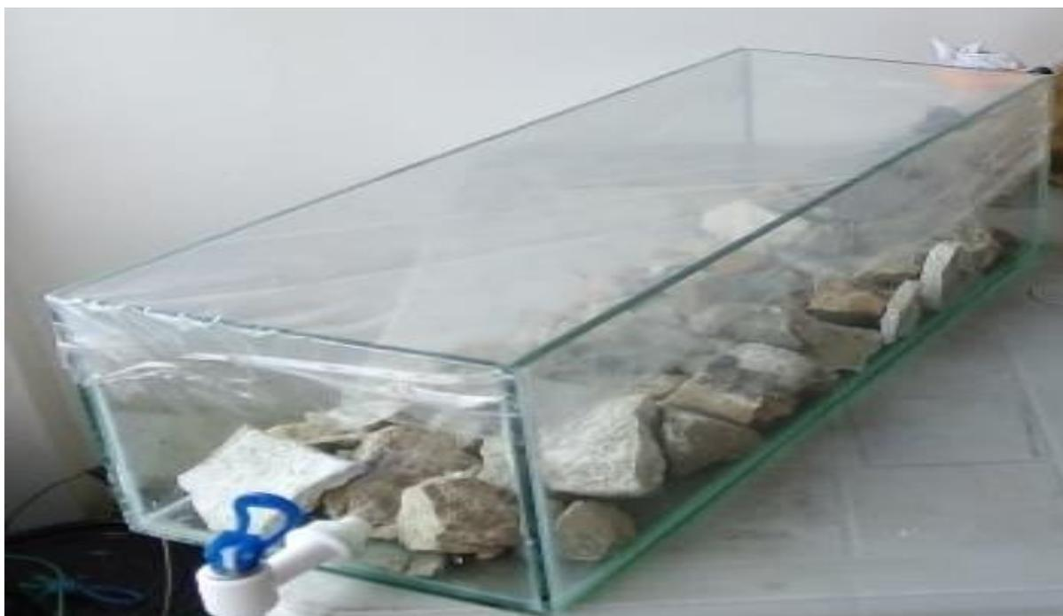
Figura 10. Prototipo experimental del dren anóxico calizo al inicio del tratamiento del drenaje ácido de mina.
