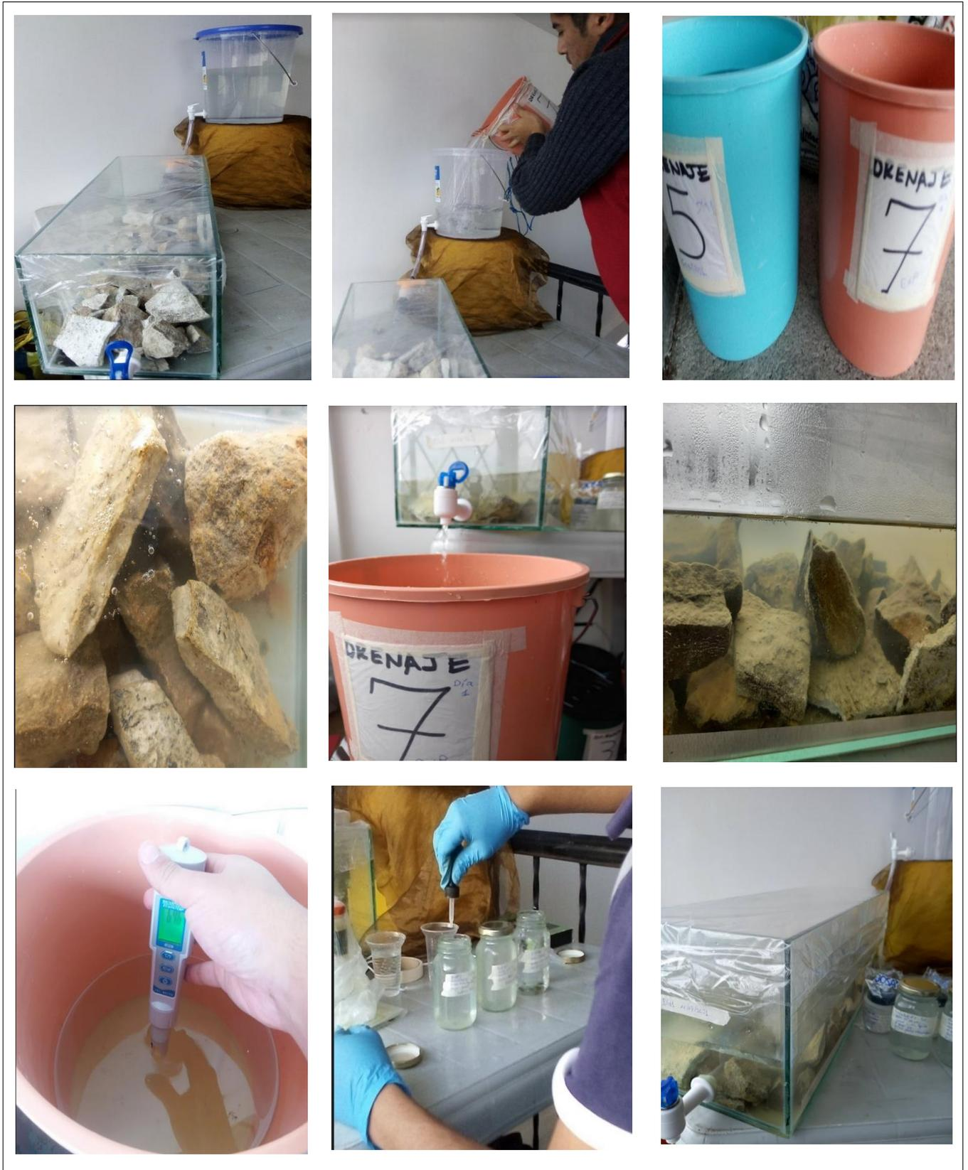
Anexo 3. Diseño del prototipo experimental del dren anóxico calizo (dimensionamiento de acuerdo al ancho, largo y profundidad).
