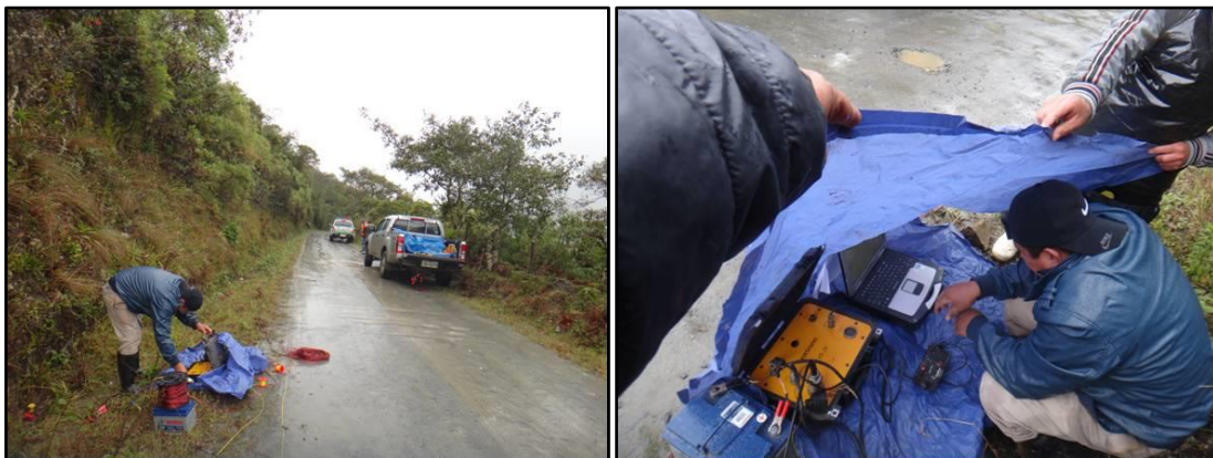
Fotografía 2. A) Ensayo refracción sísmica 1 B) Ensayo refracción sísmica 2 Fuente: La Autora, 2021
