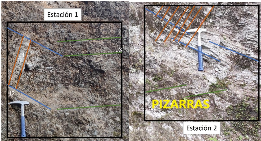
Figura 39. Estaciones de toma de datos del macizo rocoso N°1 Elaborado por: La Autora, 2021
