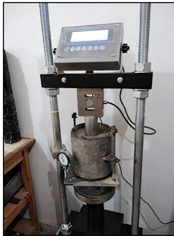
Fotografía 6. Colocación de la Probeta en la máquina para CBR y aplicación de las cargas Fuente: La Autora, 2021
