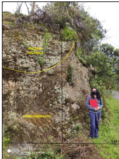
Fotografía 9. Afloramiento 2: Conglomerados cuyos clastos son medianamente redondeados que van de 2 a 10 cm de diámetro.
