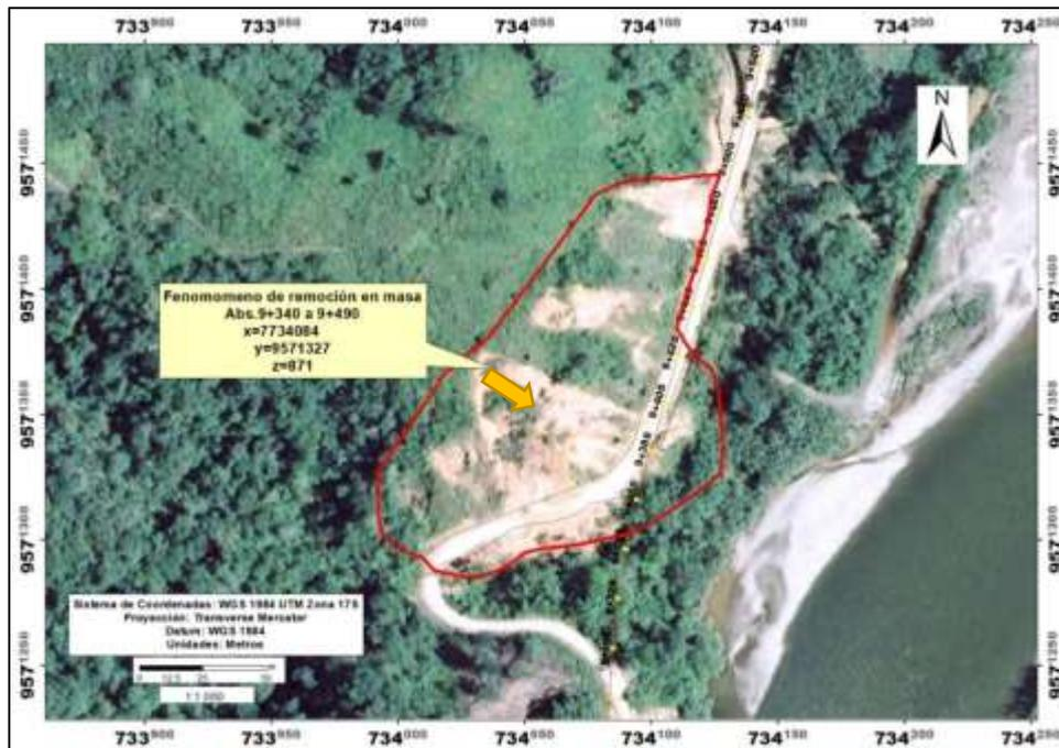
**Figura 47.** Deslizamiento identificado en la abs. 9+340 a 9+490.
