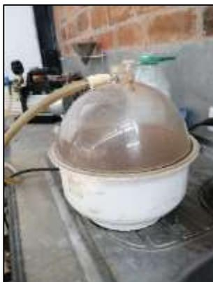
**Fotografía 9.** Colocación del picnómetro en la bomba de vacíos.
