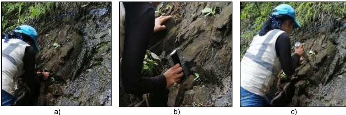
**Fotografía 11.** a) Datos estructurales con la brújula. b) Rugosidad con peine de Barton y c) Resistencia a la compresión simple mediante esclerómetro.
