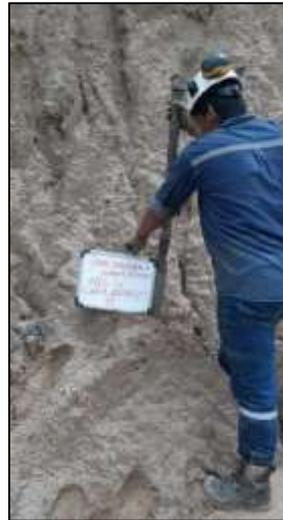
**Fotografía 1.** Extracción de muestras inalteradas con un tubo Shelby.
