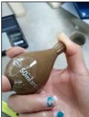
**Fotografía 8.** Agitación de la muestra para revolverla.
