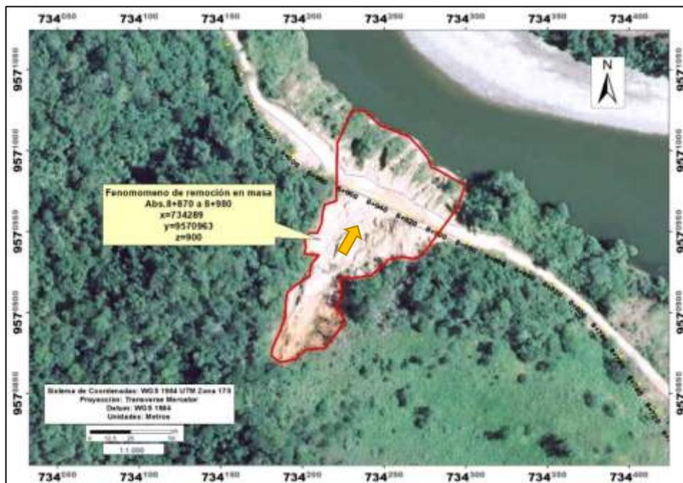
Figura 46. Deslizamiento identificado en la abs. 8+870 a 8+980.
