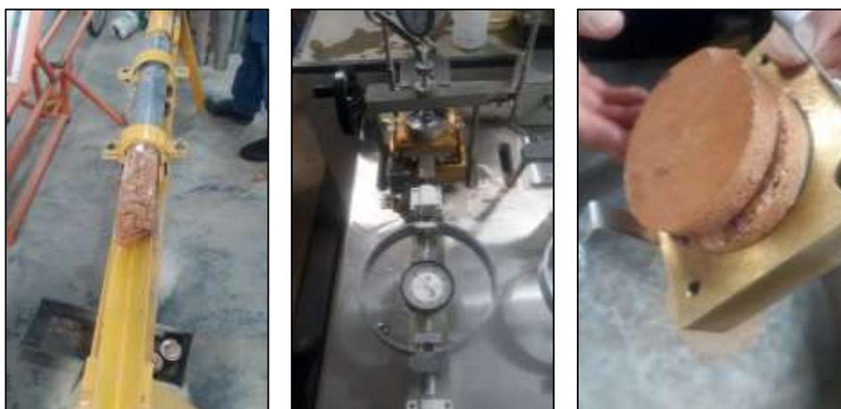
**Fotografía 2.** a) Extracción de muestra. b) Ensayo de corte directo. c) Muestra fallada.
