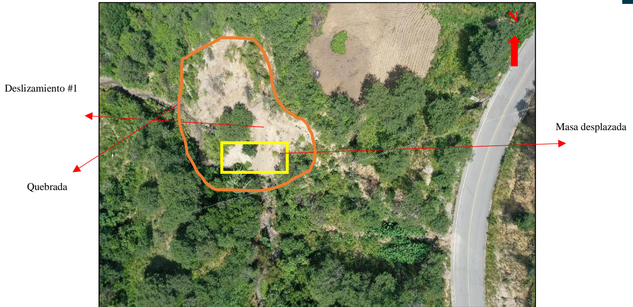
Figura: Fotointerpretación de deslizamientos.
