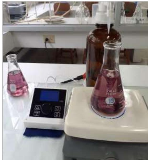
**Figura 27:** Titulación de muestras con solución de ácido sulfúrico
