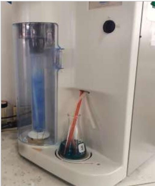
**Figura 26:** Destilación de muestras de nitrógeno con ácido bórico e hidróxido de sodio
