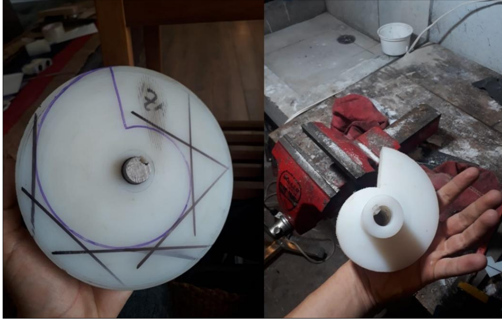
Figura 55. Torneado de la leva, corte de su perfil, chaveta y chavetero. Fuente: Propia.
