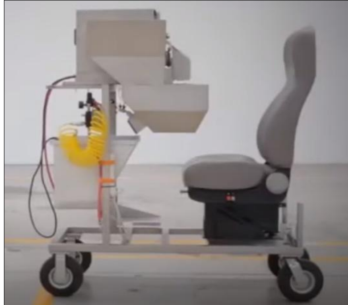
Figura 5. Despicatora Semiautomática. Fuente: (Chicas, 2015). Nota: El operador coloca el par de pollitos a despicar en frente de él, para posteriormente dejarlos caer en una bandeja en la parte inferior.
