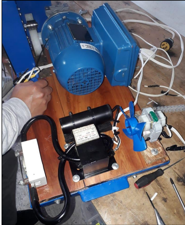
Figura 61. Cableado del motor, el cauterizador y el final de carrera. Fuente: Propia.
