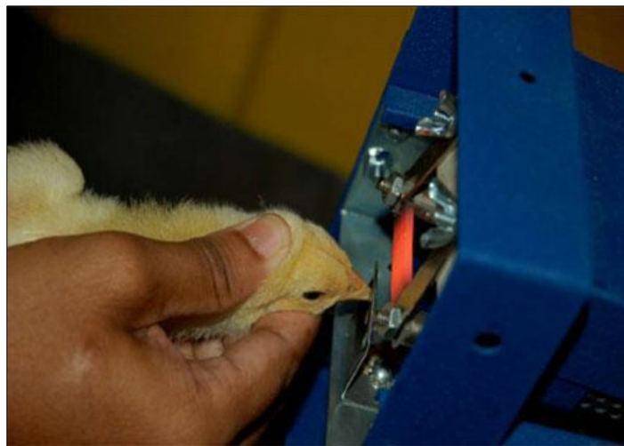
Figura 3. Despique en pollitos con una despicatora manual. Fuente: (El Sitio Avícola, 2016). Nota: La bajada de la cuchilla se controla por medio de un pedal, y la cuchilla se calienta mediante un transformador reductor de voltaje.
