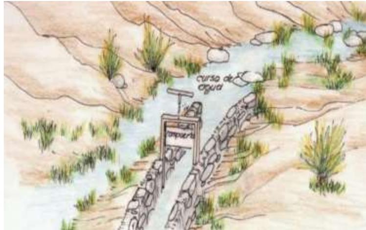
**Figura 2:** Bocatoma con compuerta de cierre
