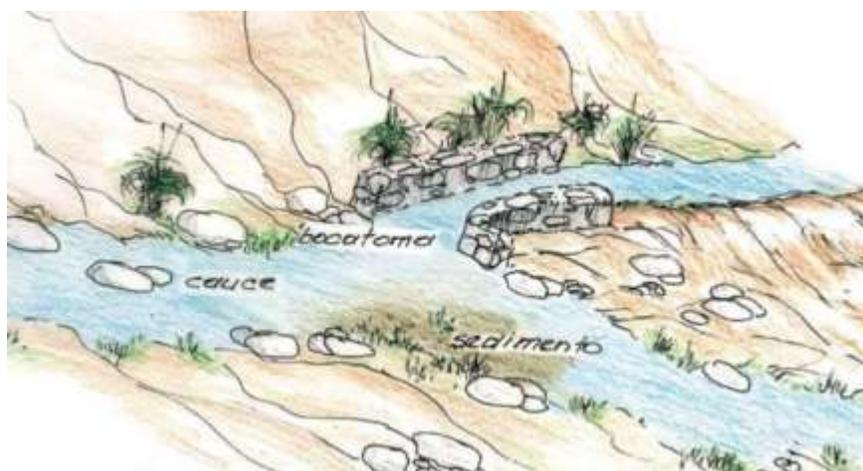
**Figura 1:** Captación a través de bocatoma libre.
