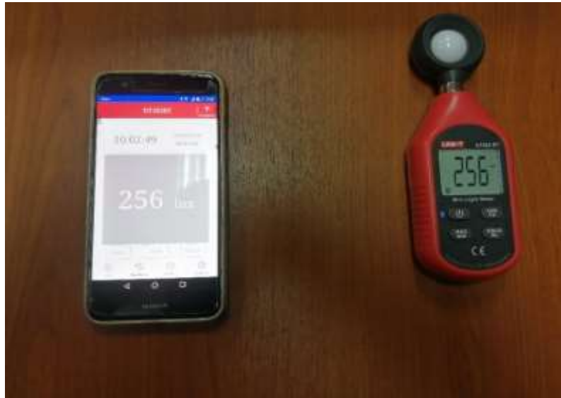
Figura 39 Medidas tomada luxómetro de marca UNI-T. Fuente: Propia
