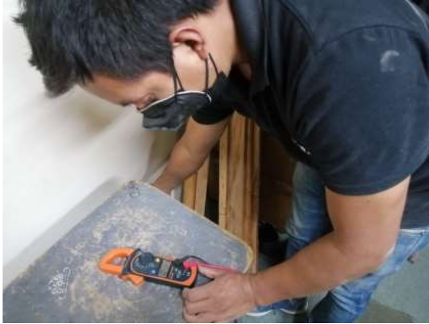
Figura 21 Medición de variable eléctrica de tomacorriente Fuente: Propia
