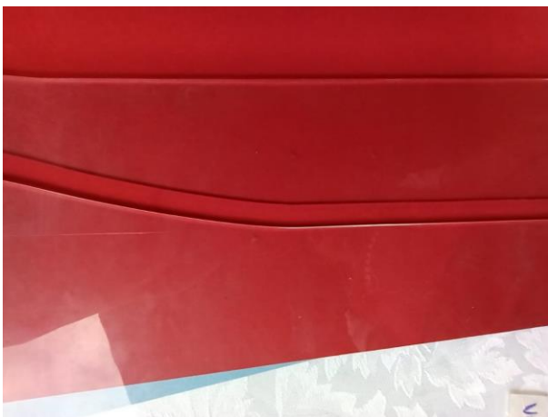
Figura 59. Ruptura de vidrio fuera de la ruta por demarcado débil.
