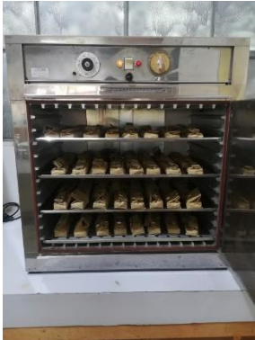
Figura 35. Secado de muestras de grano en estufa.
