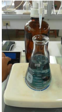
Figura 37. Titulación, determinación de concentración de proteína.
