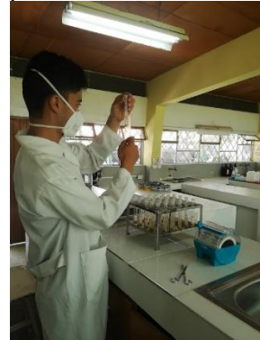
Figura 36. Toma de altura de espuma, estimación contenida de saponina.
