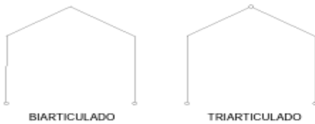
Figura 15. Estructura de pórticos biarticulados y triarticulados.
