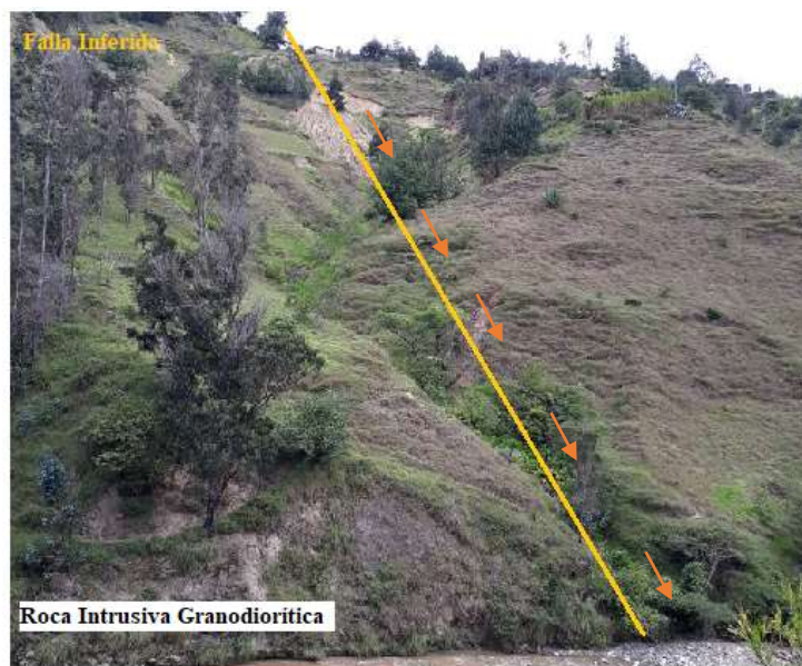
Figura 46: Falla inferida localizada en el intrusivo granodiorítico en el barrio Jesús María.
