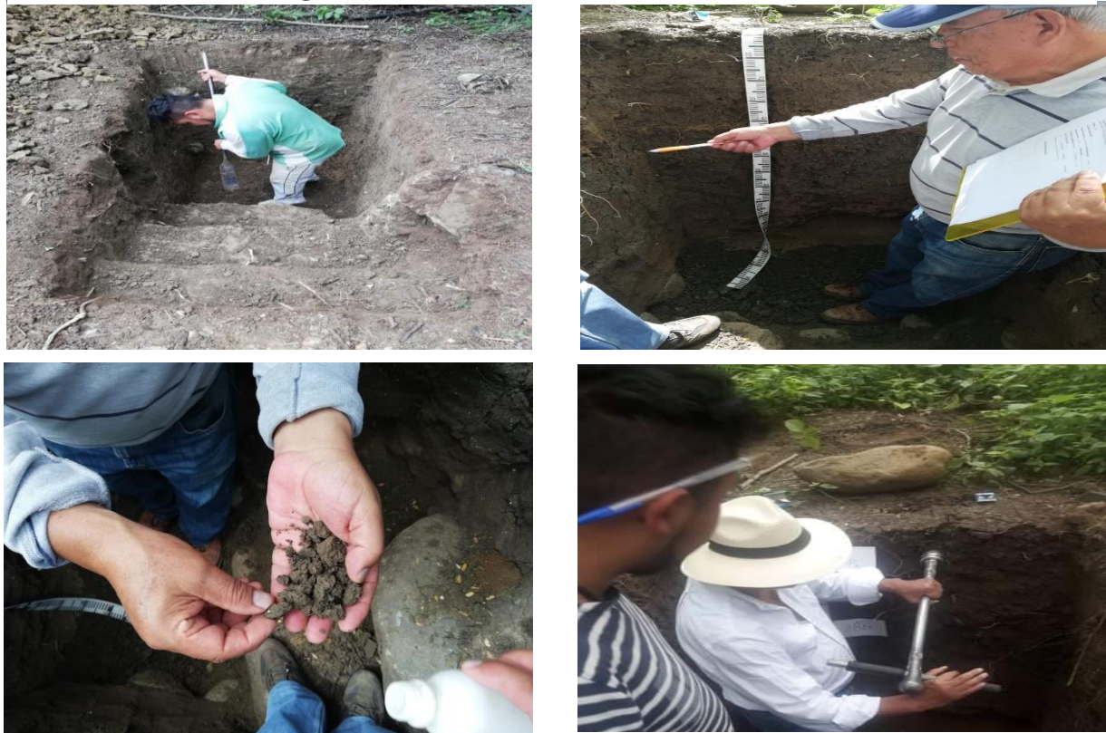
Figura 18. Realización de calicatas y descripción de perfiles.
