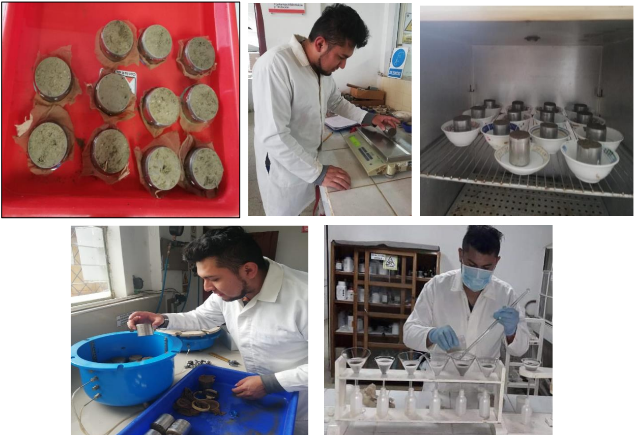
Figura 20. Determinación de las constantes hidrofísicas en el laboratorio de suelos de la Universidad Nacional de Loja.
