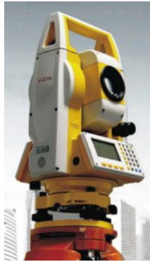
Figura 9 Estación total SOUTH series NTS-330R4
