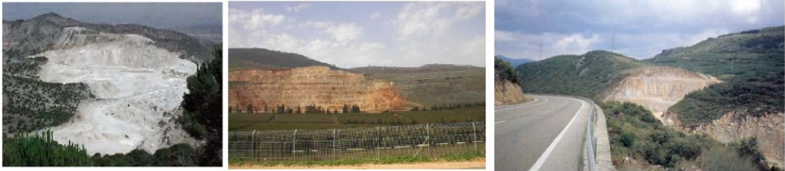
Figura 23 De izquierda a derecha se aprecia una cantera por avance frontal; Excavación descendente y abandono de talud final y Avance lateral
