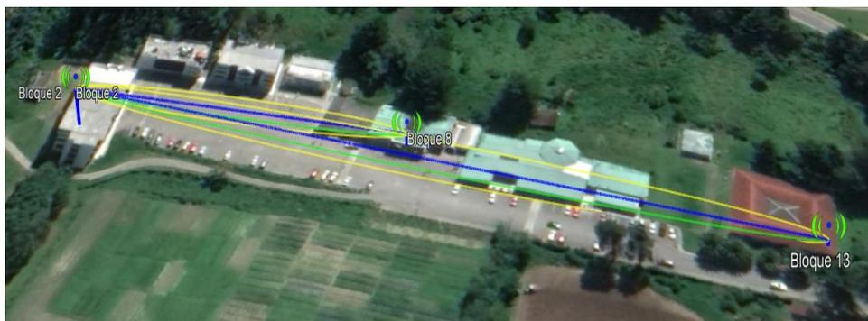
**Figura 16** Evaluación para la ubicación de la puerta de enlace con el bloque 8 y 13. Fuente: Elaboración propia. La grafica es obtenida del programa de Google Earth pro, representa la conexión del enlace de forma directa con la línea de color azul; las estaciones se representan como puntos de acceso inalámbrico que indica a la altura que se va a encontrar; y, las líneas amarillas y verdes representa de una forma esquemática las zonas de Fresnel que se encuentran los enlaces
