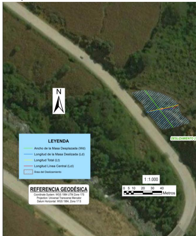
Figura 33. Caracterización Morfométrica del Deslizamiento 2 con las herramientas del software ArcMap 10.8.
