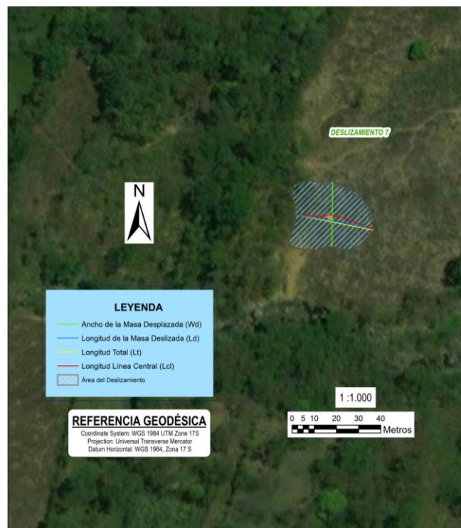
Figura 38. Caracterización Morfométrica del Deslizamiento 7 con las herramientas del software ArcMap 10.8.
