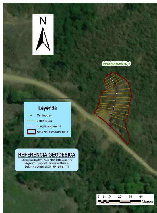
Figura 31. Representación y obtención de la Longitud de la Línea Central, proceso de vectorización como referencia para los deslizamientos visualizados en las Ortofotos.
