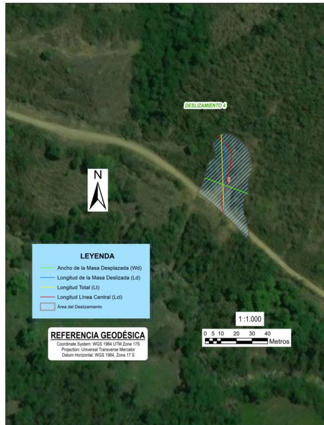
Figura 35. Caracterización Morfométrica en el Deslizamiento 4 con las herramientas del software ArcMap 10.8.
