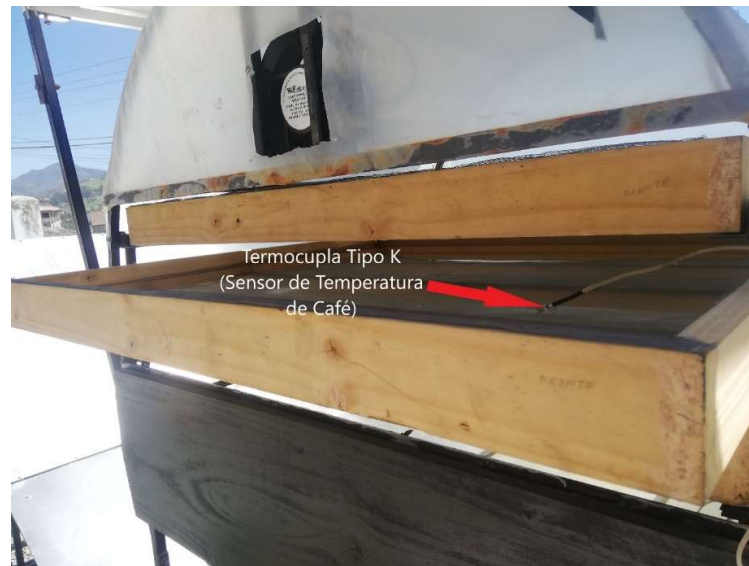
Ilustración 41: Disposición de Sensor de Temperatura de Café. Fuente (Autor)
