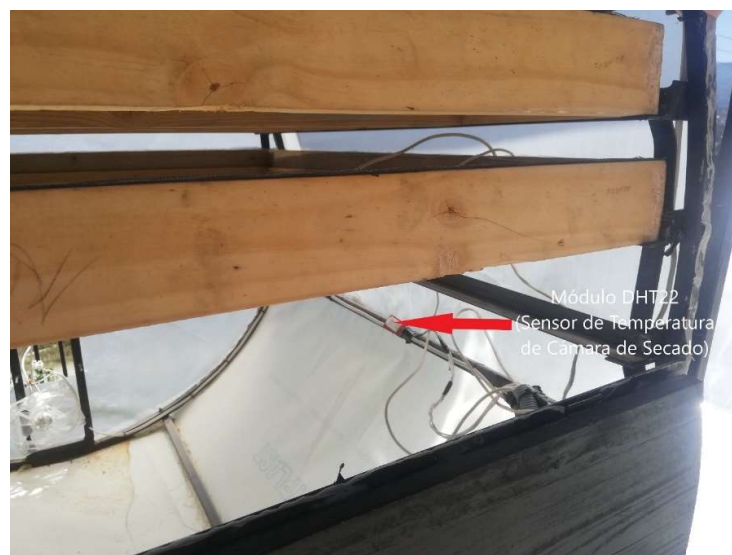
Ilustración 41: Disposición de Sensor de Temperatura de Café. Fuente (Autor)
