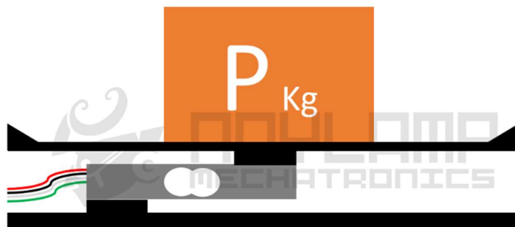
Ilustración 22: Instalación celda de Carga. Fuente(Naylampmechatronics, 2015)
