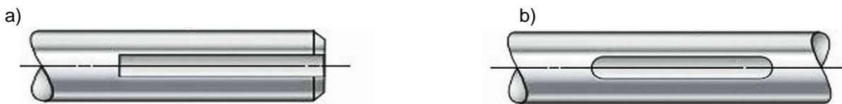
**Figura 14.** Tipos de chaveteros: a) perfil Recto y b) terminación curva. Fuente: (Mott R. , 2015)
