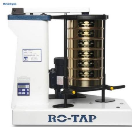
*Figura 3.* Máquina con pila de tamices. Fuente: (Steinhart, 2012)
