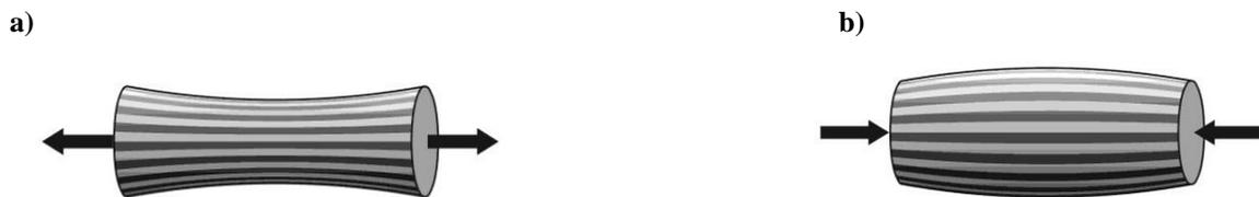
**Figura 6.** Efectos de carga: a) tracción y b) compresión. Fuente: (Díaz de León, 2018)
