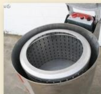
Figura 31. Escurridor tipo centrifuga industrial
