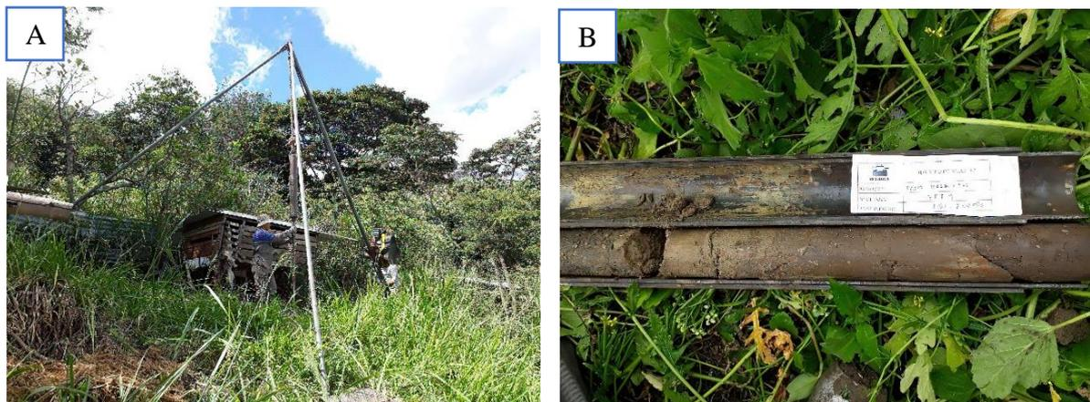
Fotografía 4. A) Disposición del equipo SPT y B) Muestra etiquetada.
