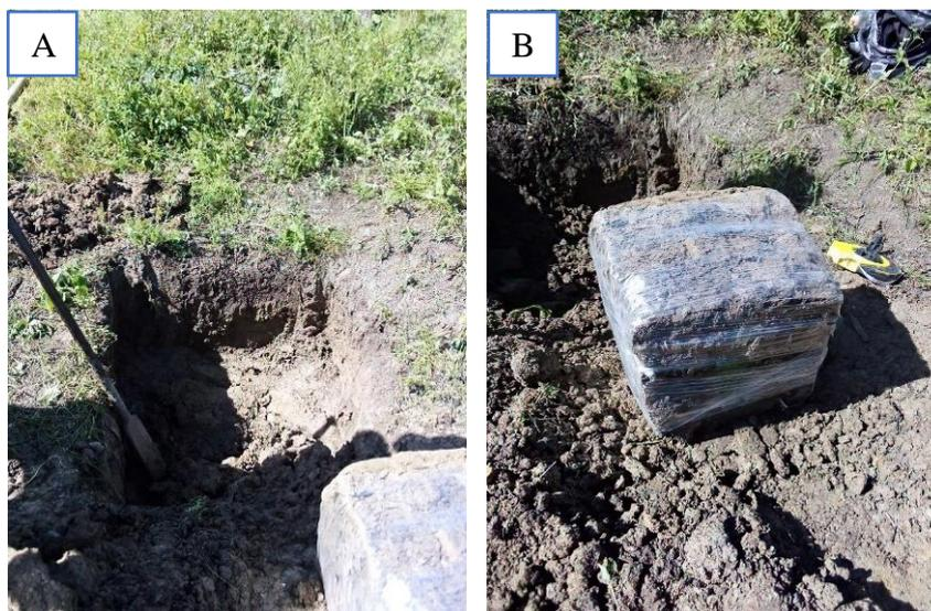
**Fotografía 5.** A) Apertura de la calicata y B) Muestra inalterada.
