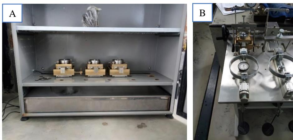
**Fotografía 8.** A) Muestras en la cámara húmeda y B) Muestra en el equipo de corte directo.
