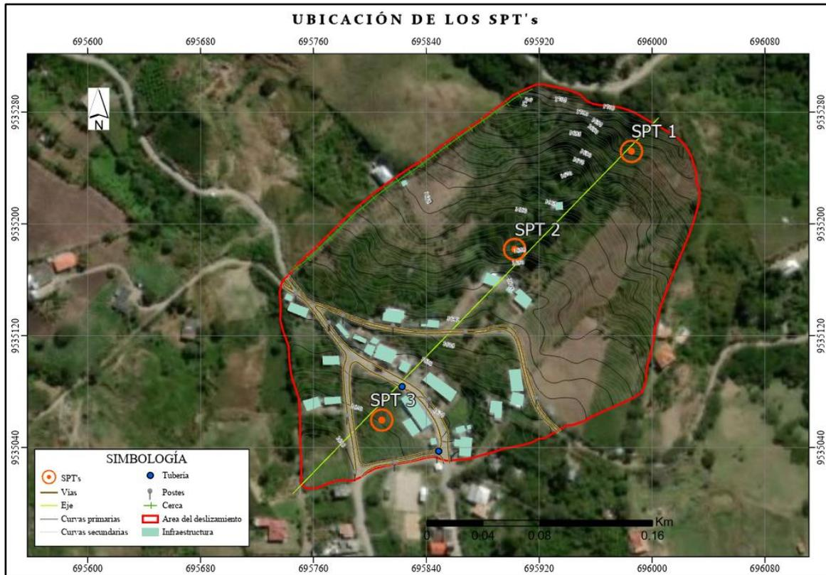
**Figura 43.** Ubicación de los SPT's en el deslizamiento en estudio.
