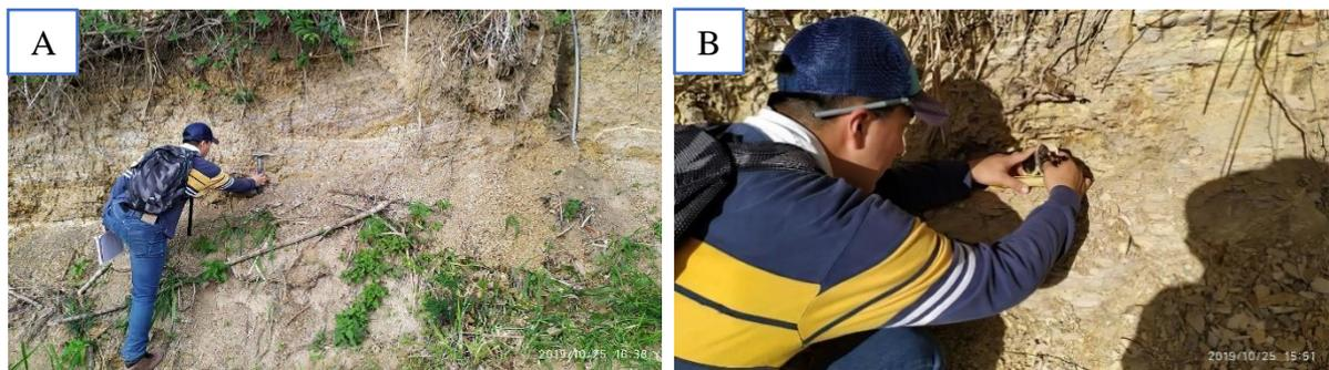
**Fotografía 2.** A) Descripción de afloramientos y B) Toma de medidas estructurales.
