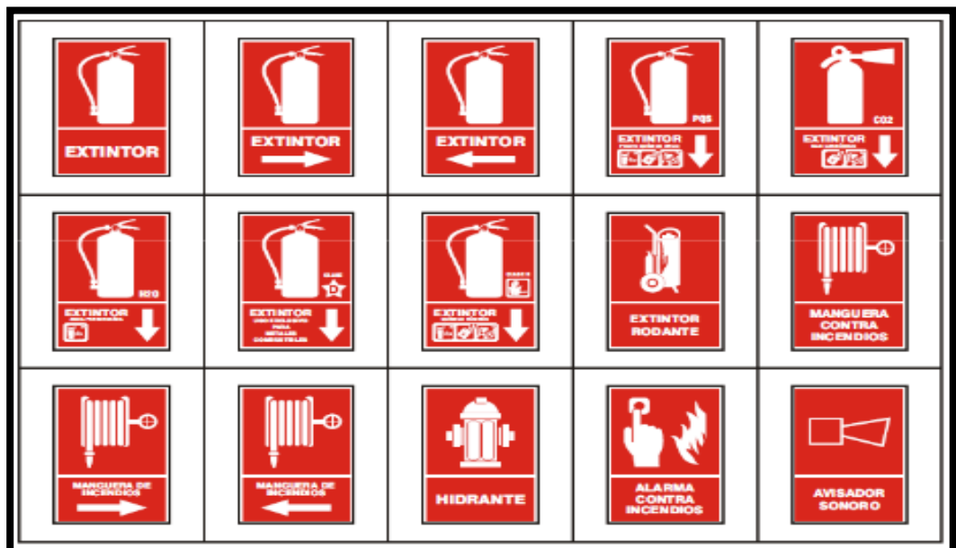
Ilustración 5 Señales de Emergencia
