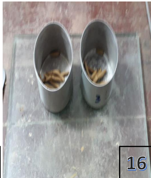
Foto 15, 16 y 17. Ensayo para determinar el límite plástico
