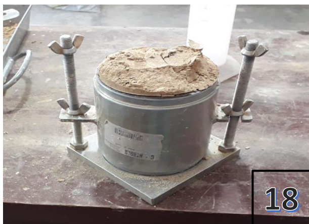
Foto 18 y 19. Ensayo de compactación mediante el Proctor estándar
