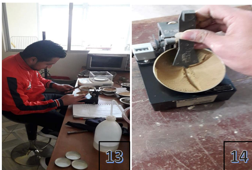
Foto 13 y 14. Ensayo para determinar el límite líquido (Copa de Casagrande)
