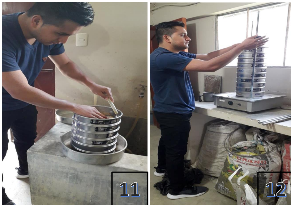
Foto 11 y 12. Granulometría por lavado del tamiz 200 y secado al horno
