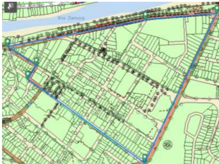
Figura 18. Mapa eléctrico de circuitos de media tensión que alimentan el área de estudio
