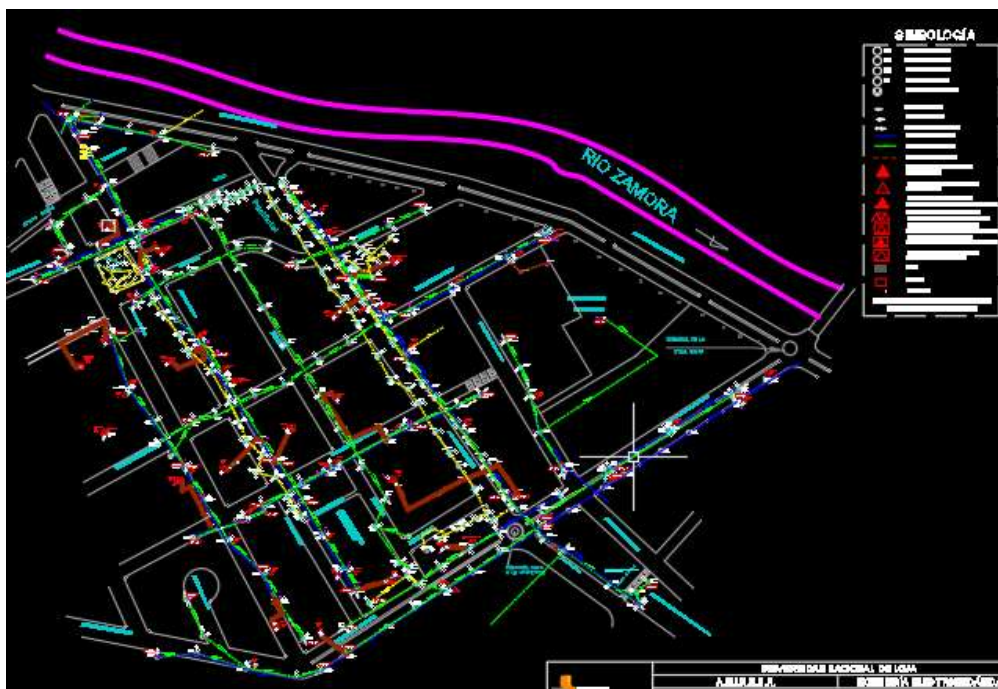
Figura 21. Detalle de la red aérea existente
