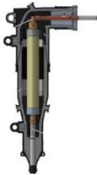
Figura 8. Composición Detallada de Codo Portafusible Chardon
