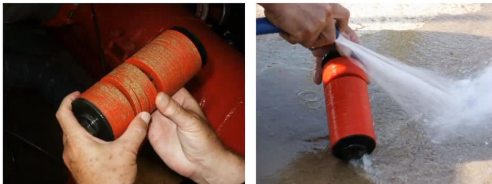
Figura 28. Limpieza de cartucho de anillas del filtro.
