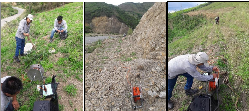
Fotografía 5: A) Ensayo refracción sísmica 1 B) Ensayo refracción sísmica 2 C) Ensayo refracción sísmica 3
