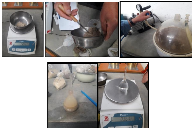
Fotografía 3: Ensayo de densidad A) Peso de la muestra B) Colocación del material dentro del picnómetro c) Aplicación de la bomba del vacío a la muestra en el picnómetro D) Incorporación del agua destilada E) Peso del picnómetro con agua destilada.
