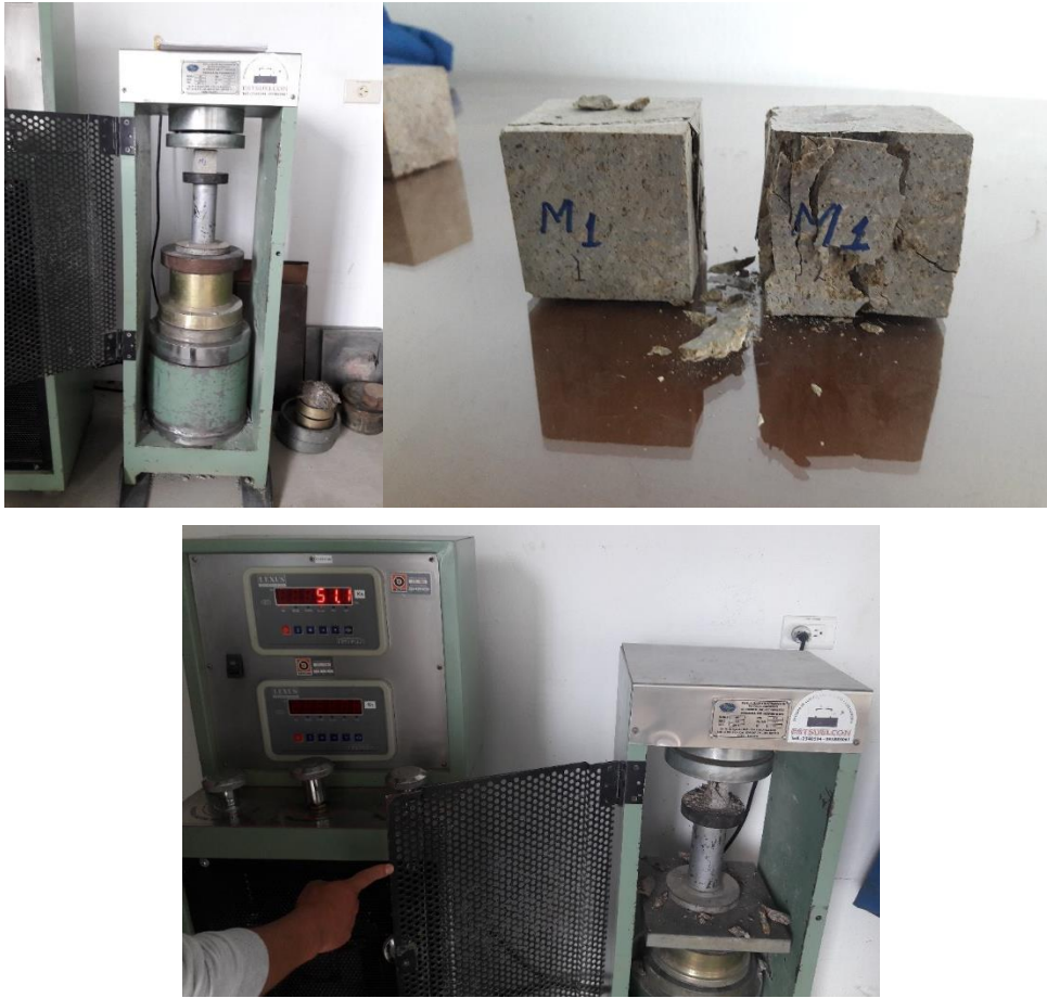
Fotografía 2: A) Ensayo de compresión a la Muestra 1 (M1) B) Cubos ensayados C) Ensayo de compresión al testigo de roca
