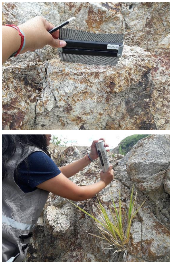
Fotografía 6: A-B) Recolección de información para la caracterización del macizo rocoso: Rugosidad con peine de Barton y Resistencia a la compresión simple mediante esclerómetro.
