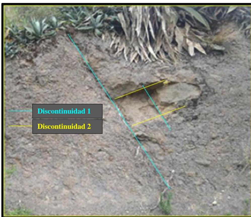
*Fotografía 31. Talud 1, usado para la caracterización Geomecánica*
