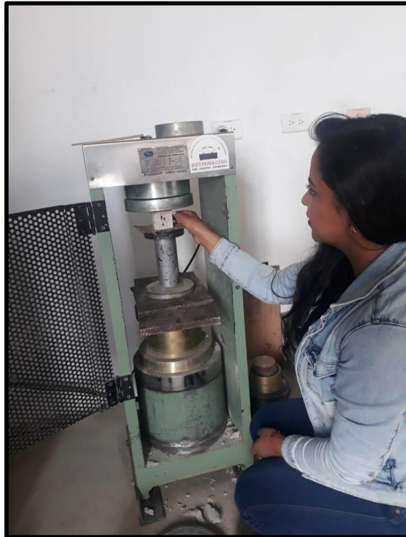
*Fotografía 7. Colocación de muestra cubica para el ensayo de compresión simple*
