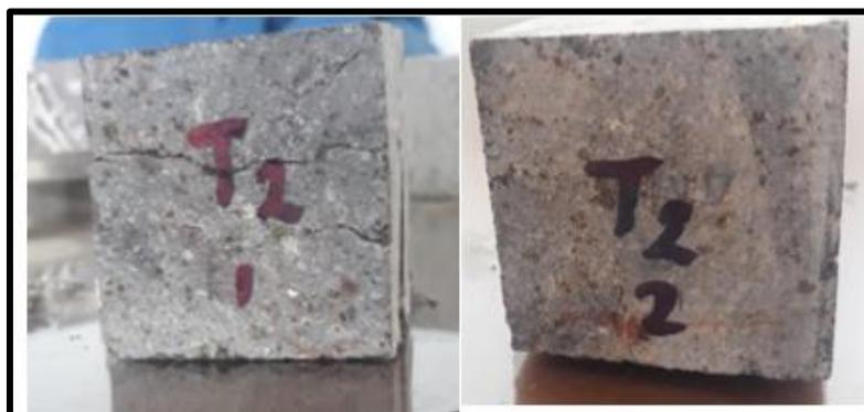
**Fotografía 35.** Cubos de roca de Talud 2, después de aplicar la carga uniaxial
