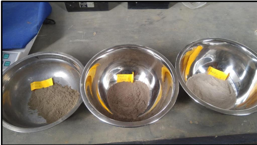
*Fotografía 9. Muestras de rocas trituradas y tamizadas.*
