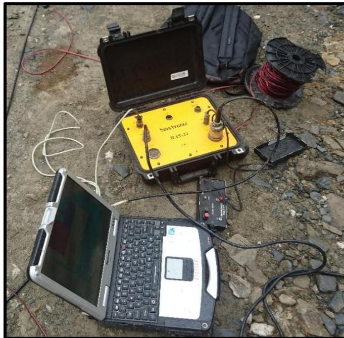
**Fotografía 6** Equipo de sismica SEISTRONIX RAS 24
