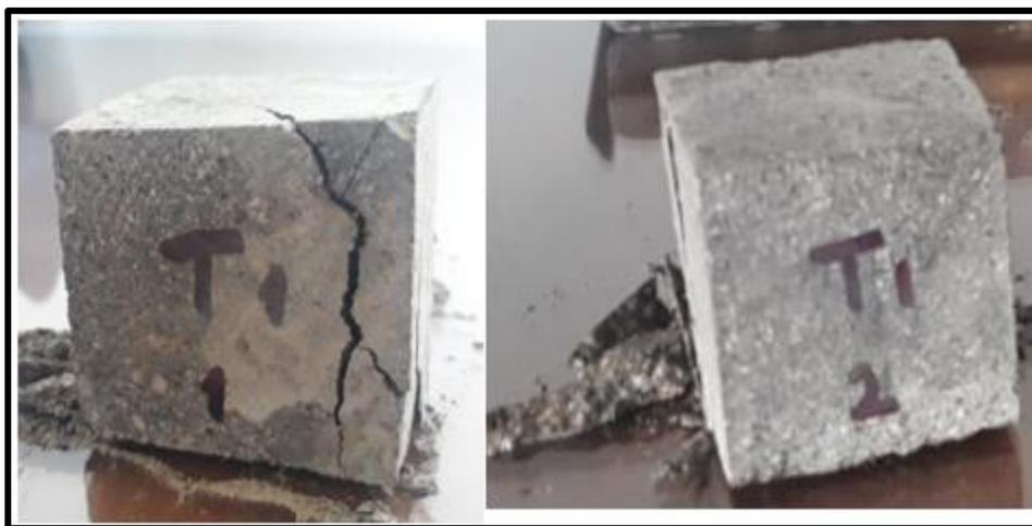
**Fotografía 34.** Cubos de roca de Talud 1, después de aplicar la carga uniaxial
