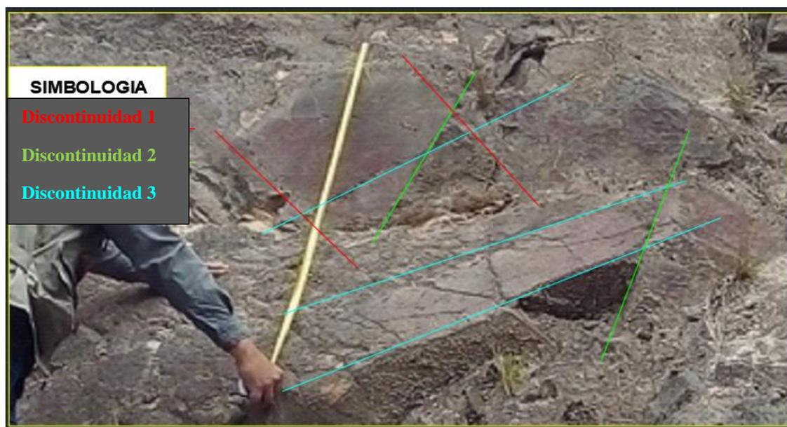
*Fotografía 32. Talud 2, usado para la caracterización Geomecánica*
