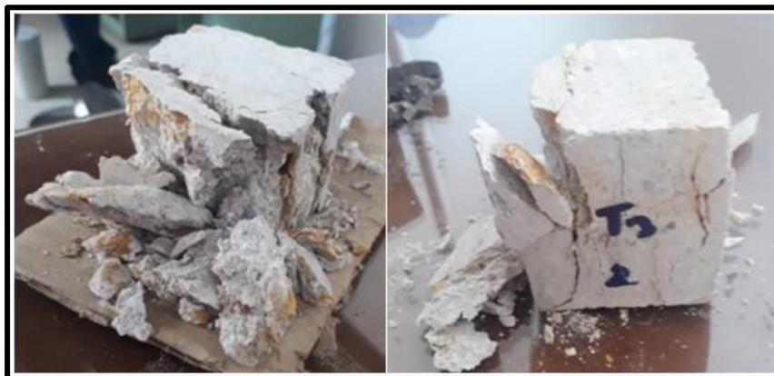
*Fotografía 36. Cubos de roca de Talud 3, después de aplicar la carga uniaxial
