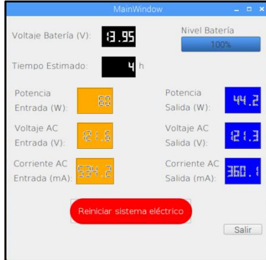
Figura 45. Ventana principal del software de monitoreo de parámetros eléctricos y control de reinicio eléctrico.
