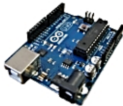
Arduino UNO con microcontrolador en formato DIP
