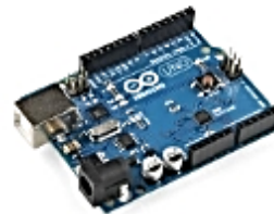
Arduino UNO con microcontrolador en formato SMD
