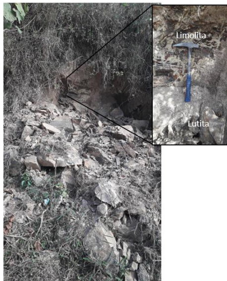
Figura 21. Foto del afloramiento de Lutitas y Limolitas en el cantón Olmedo Fuente: La Autora (2020).
