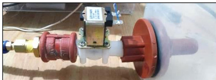
Figura 75. Ubicación de electroválvula en el sistema de calentamiento por inducción.
