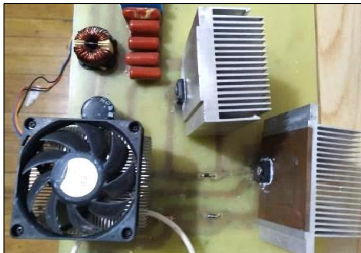
Figura 74. Disipadores y sistema de ventilación de circuito de potencia.
