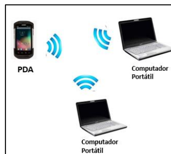
Figura 6. Esquema de una red ad-hoc.
