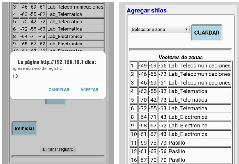
Figura 70. Interfaz de recalibración del sistema de localización. Fuente: Autor.
