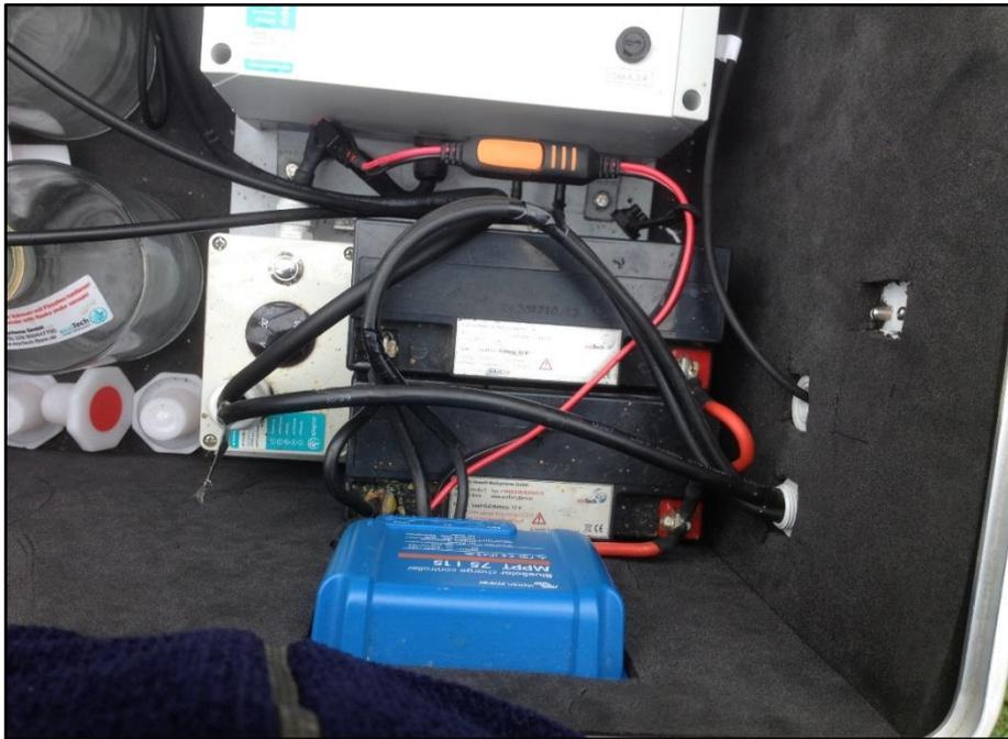
Figura 30. Implementación de batería y regulador de carga.
