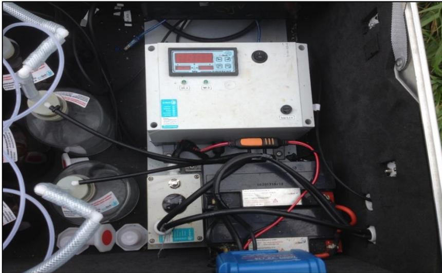
Figura 31. Implementación de controlador electrónico de vacío.
