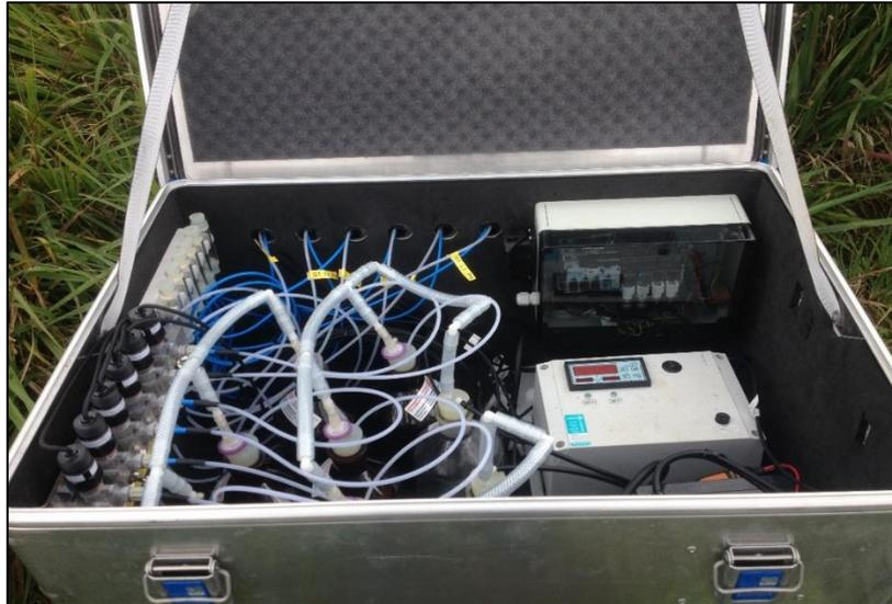
Figura 35. Ensamblaje final del sistema de monitoreo.
