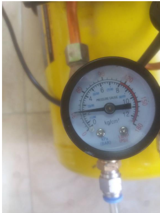
Figura 52. Fuente de aire comprimido a 29 psi. Fuente: Autor
