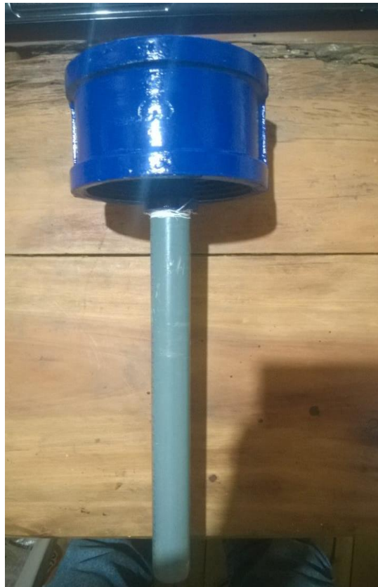
Figura 41. Tapa superior de la cámara y ensamble de tubería de descarga. Fuente: Autor.
