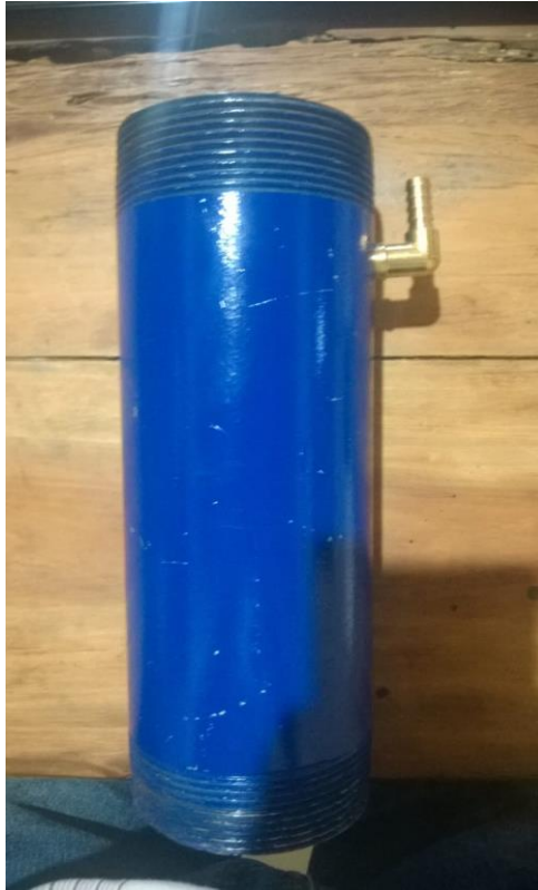
Figura 32. Cámara de la bomba. Fuente: Autor.
