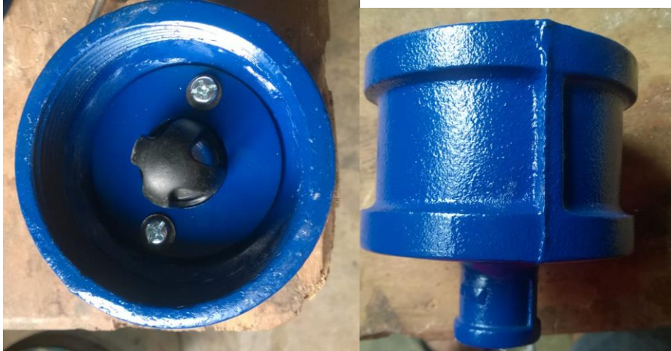
Figura 36. Tapa inferior de la cámara. Fuente: Autor.
