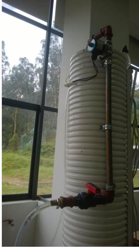
Figura 63. Válvula de cierre rápido de emergencia para sensores SND1 SND2 Y EVC. Fuente:
