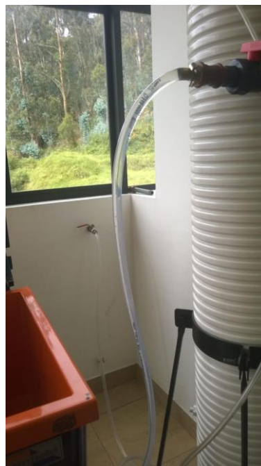
Figura 74. Conexión de la línea de carga de agua hacia la reserva a una red en el laboratorio.
