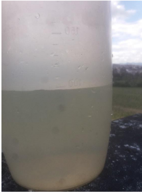
Figura 51. Volumen recolectado en un ciclo 0.98 litros. Fuente: Autor.
