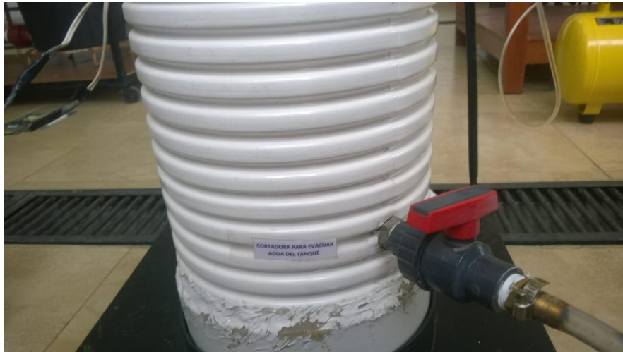
Figura 60. Válvula de cierre rápido para purgar el agua de la reserva. Fuente: Autor.
