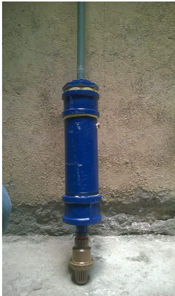
Figura 43. Bomba neumática ensamblada. Fuente: Autor.
