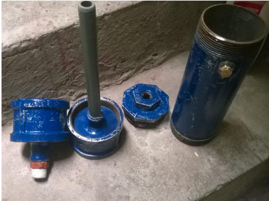
Figura 56. Partes de la bomba neumática: cámara, tapa superior, tapa inferior, línea de descarga interna. Fuente: Autor
