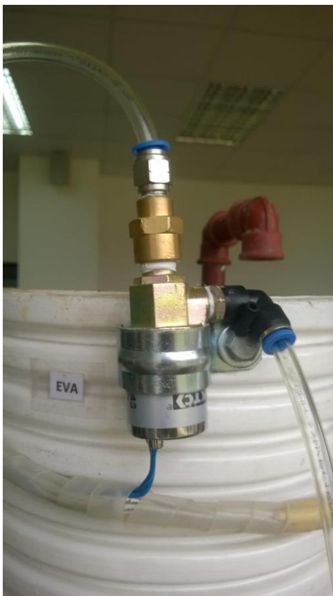
Figura 92. Conexión de la tubería de aire del compresor a la electroválvula EVA. Fuente: Autor. k) Regular la presión de aire para el proceso de bombeo 29 psi, ver figura 93.
