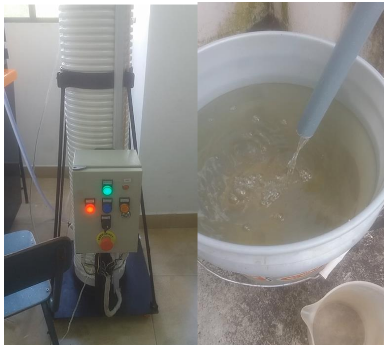
Figura 50. Sistema de bombeo en carga. Fuente: Autor.
