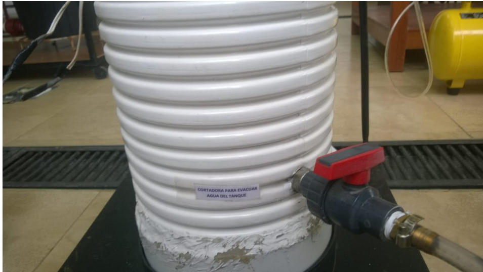
Figura 73. Válvula de cierre rápido para purgar el agua de la reserva. Fuente: Autor.
