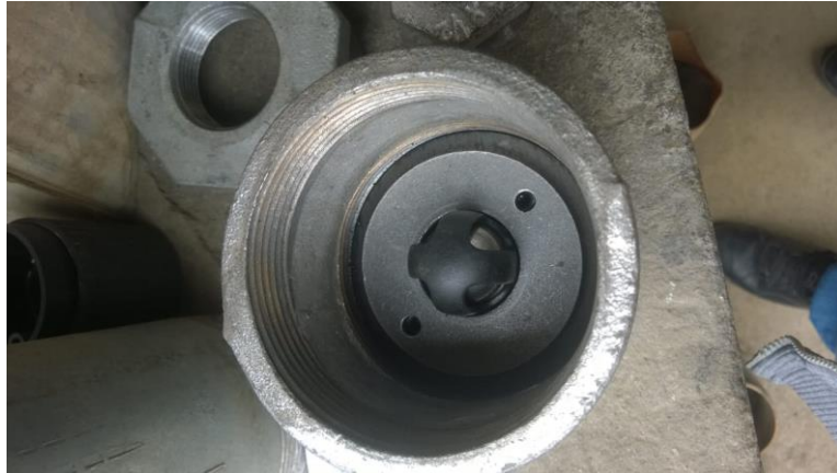
Figura 35. Ensamble de válvula TR1 en la parte superior de la tapa (tapa inferior de la cámara).
