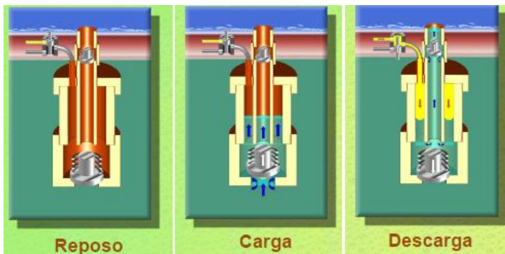
Figura 8: Ciclo de trabajo del dispositivo neumático.
