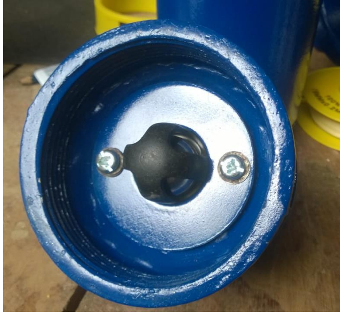
Figura 40. Ensamble de válvula TR2 en la parte superior de la tapa (tapa superior de la cámara). Fuente: Autor.
