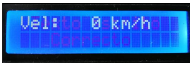
Figura 54. Velocidad obtenida por el módulo GPS con un vehículo estático. Fuente: El autor.
