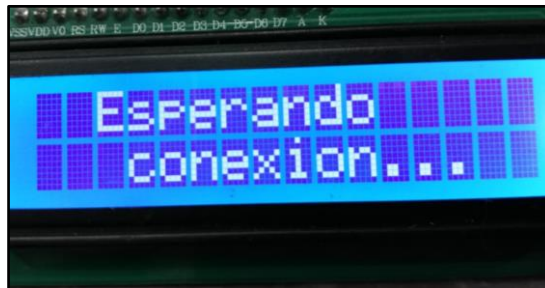
Figura 51. mensaje de espera en el que se verifica el estado de la micro SD Card. Fuente: El autor.
