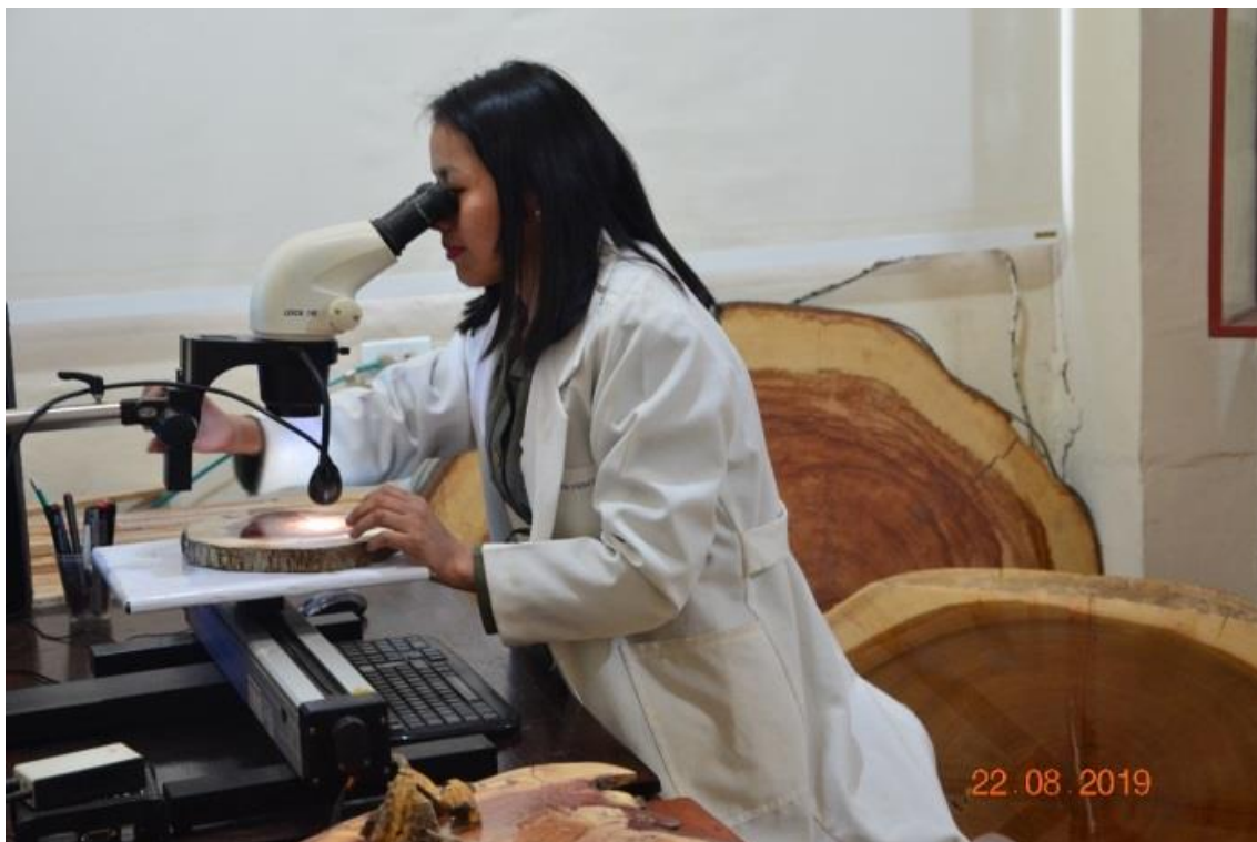
Figura 13. Sistema Lintab 6 Pro para la medición de anillos de crecimiento de Acacia macracantha .
