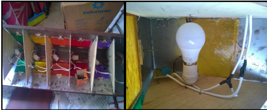
Figura 97. Colocación de focos, vidrios y adhesivos en representación de los colores establecidos por la OMS, para los niveles del IUV.
