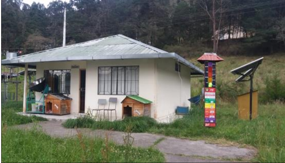
Figura 60. Colocación del solmáforo junto a la Vivienda Autosustentable, dentro de la FEIRNNR, y comprobando su funcionalidad.
