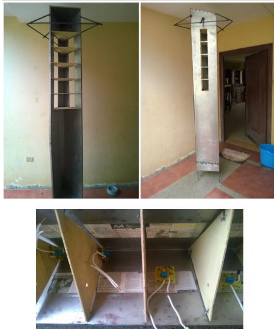
Figura 95. Seccionado interno de la estructura, para los diferentes niveles de radiación ultravioleta y colocación de circuito de potencia.
