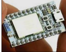
Figura 3. Tarjeta spark. Fuente: (Loureiro, 2015, pág. 30).
