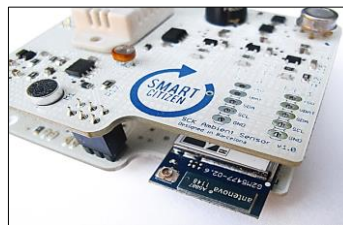
Figura 9. Dispositivo Smart Citizen. Fuente: (Fresneda, 2013).
