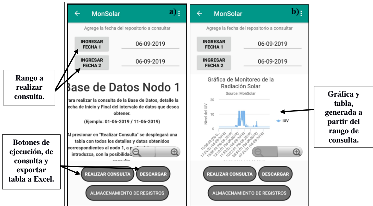
Figura 54. Interfaz del WebView. a) Ingreso del rango de datos a consultar, en función de la fecha. b) Gráfica y tabla generada, de los datos obtenidos a partir del rango ingresado.
