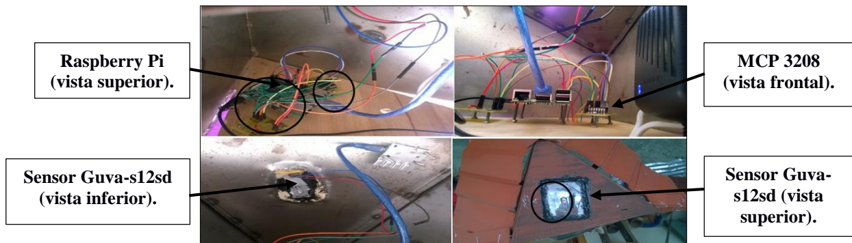
Figura 73. Interconexión entre Raspberry pi - MCP 3208 - sensor GUVVA-S12SD.
