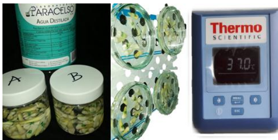
Figura 13. Especímenes sometidos a temperatura de 37°C por 7 días.
