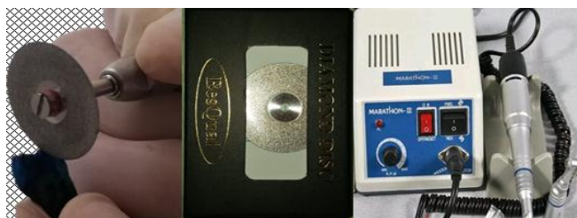
Figura 20. Muestra seccionada usando micromotor (NSK) con disco/ diamante.
