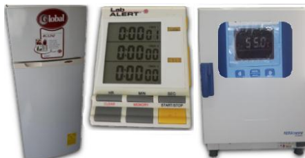
Figura 16. Implementos utilizados en el termociclado manual. Fuente: Investigación. Elaboración: Dennisse Vivanco Ludeña.
