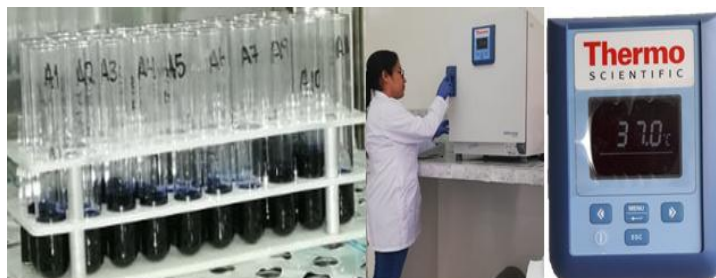
Figura 18. Muestra sumergida en azul de metileno a 37°C por 3 días.
