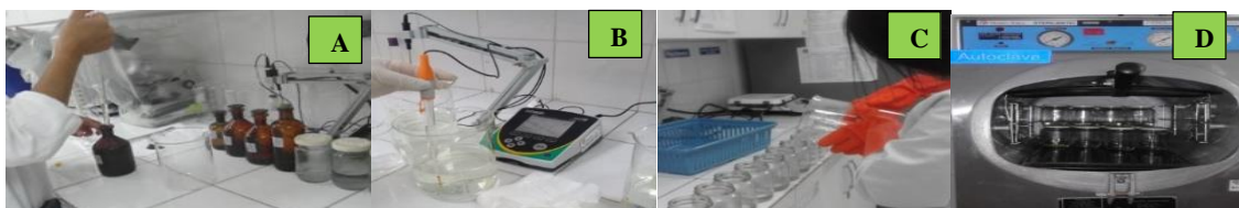
Figura 4. Preparación del medio de cultivo basal sólido MS. A) Colocación de Sales del MS, B) Ajuste de pH, C) Distribución en los frascos de vidrio, D) Esterilización.
